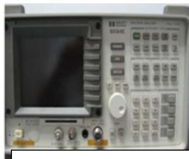
HP8594E Spectrum analyzer
