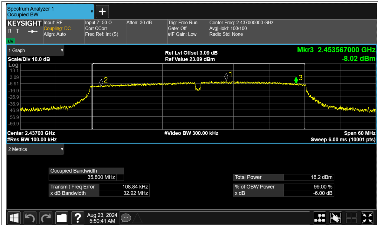
-6dB Bandwidth NVNT n40 2452MHz Ant1
