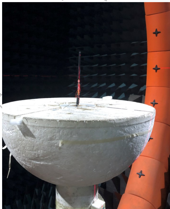
The production test position/天線測試放置位置
