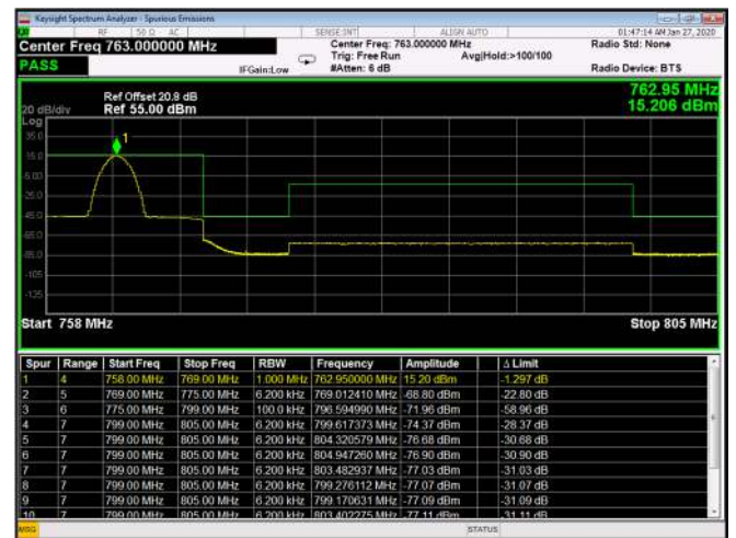
Figure 234: 16QAM 10MHz B.W.; 758-805MHz, 15kHz
