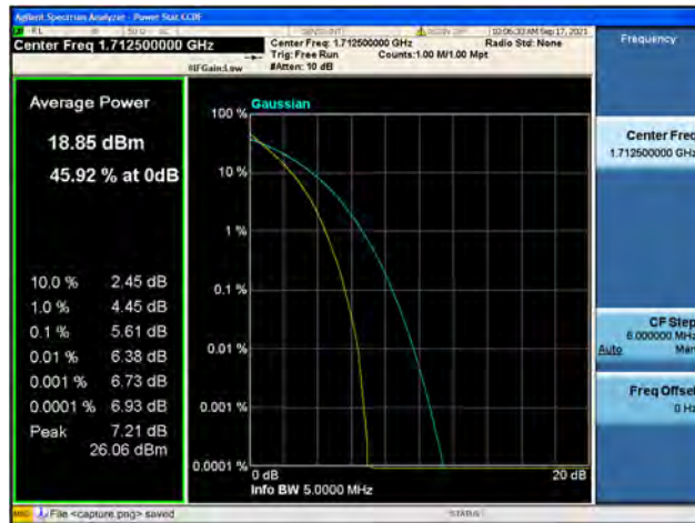
Band4 / 5MHz / Low CH / 64QAM
