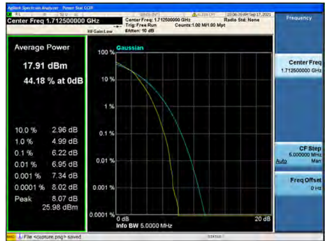
Band4 / 5MHz / Mid CH / QPSK
