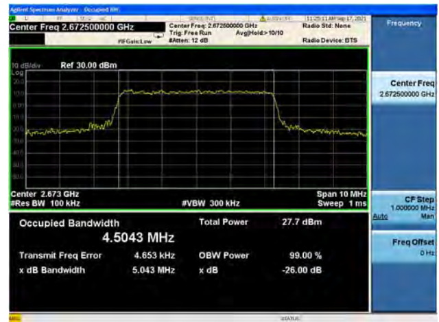
Band41 / 10MHz / Low CH / QPSK
