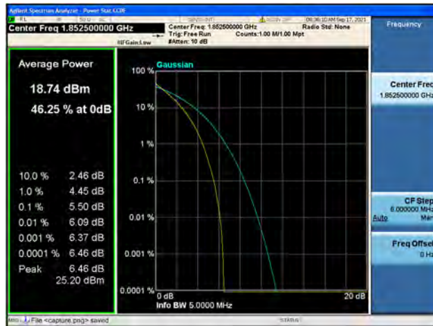
Band2 / 5MHz / Low CH / 64QAM
