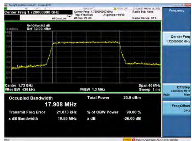
Band66 / 20MHz / Low CH / 64QAM
