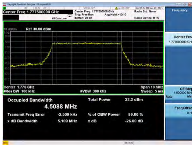
Band66 / 10MHz / Low CH / 16QAM
