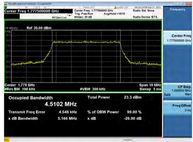
Band66 / 10MHz / Low CH / QPSK
