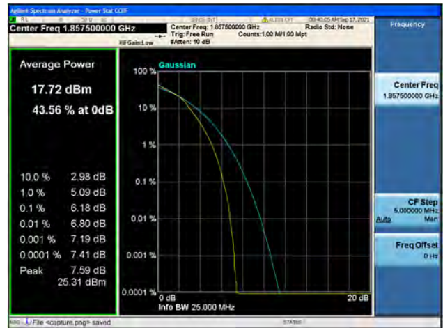
Band2 / 15MHz / Mid CH / QPSK
