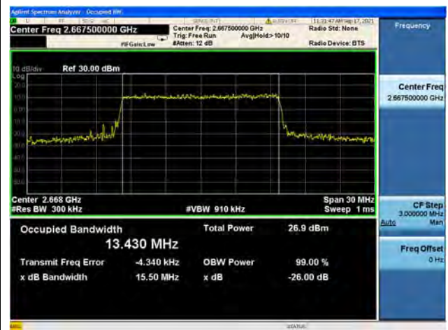
Band41 / 20MHz / Low CH / QPSK
