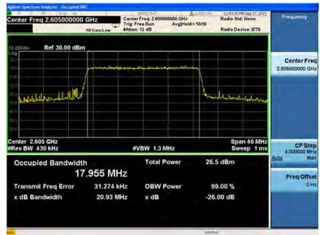
Band41 / 20MHz / High CH / QPSK
