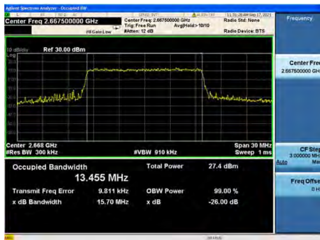
Band41 / 20MHz / Low CH / 16QAM
