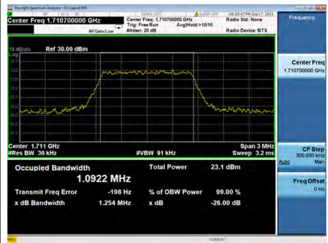
Band66 / 1.4MHz / Mid CH / QPSK
