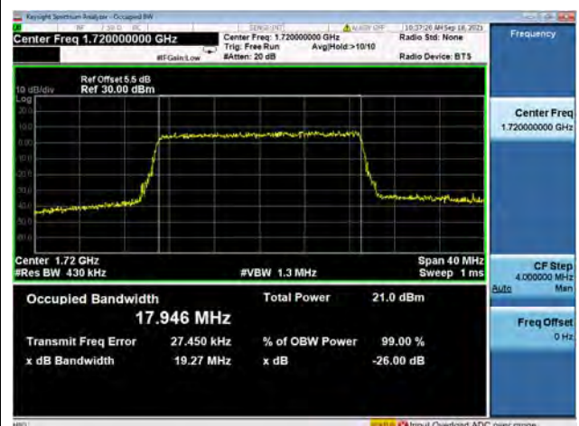
Band66 / 20MHz / Low CH / 64QAM
