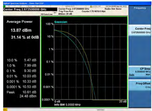
Band41 / 10MHz / Low CH / QPSK
