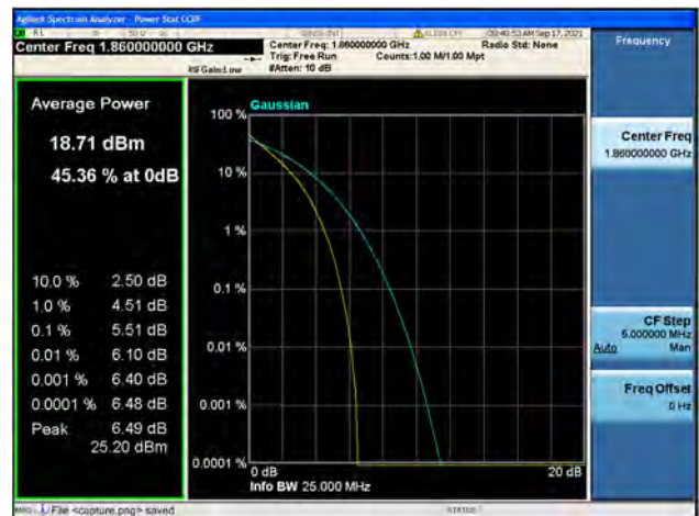
Band2 / 20MHz / Low CH / 64QAM
