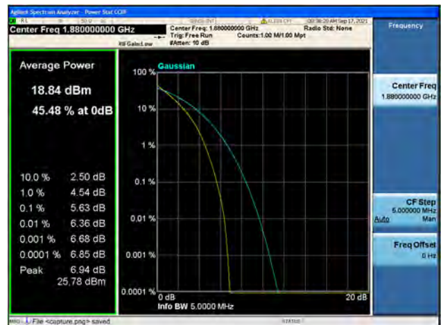
Band2 / 5MHz / Mid CH / 64QAM
