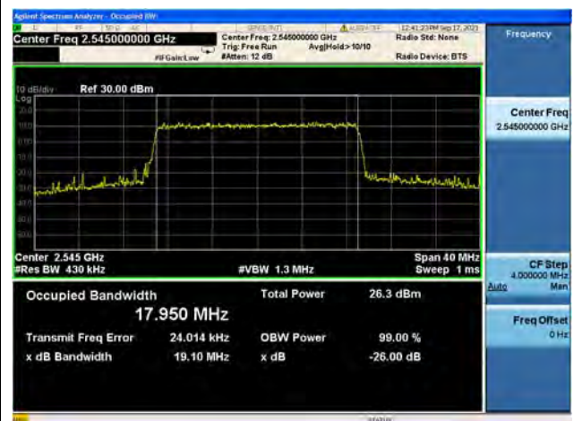
Band41 / 20MHz / Low CH / 64QAM
