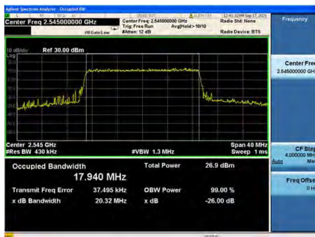
Band41 / 20MHz / Low CH / 16QAM
