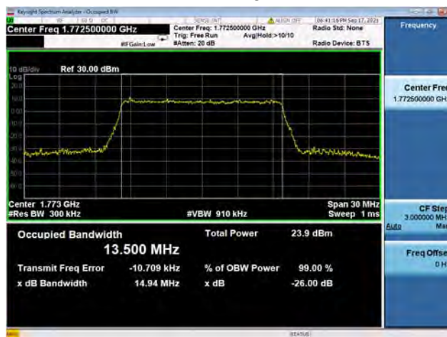
Band66 / 20MHz / Low CH / 16QAM
