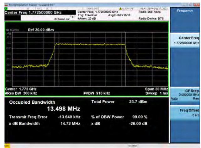
Band66 / 20MHz / Low CH / QPSK
