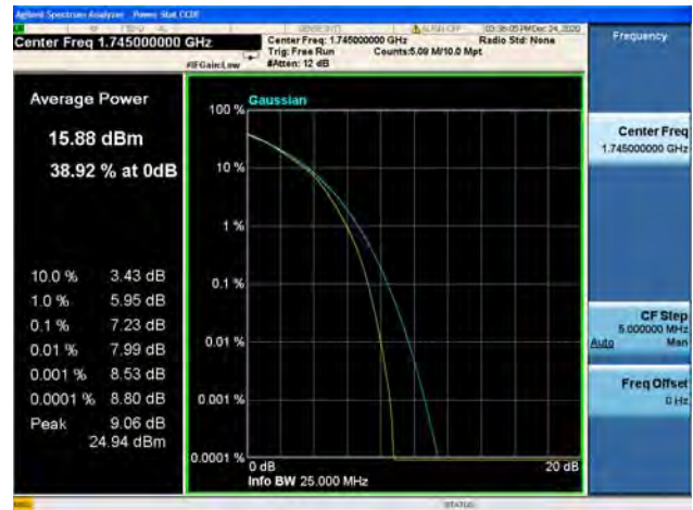
Band66 / 20MHz / High CH / QPSK
