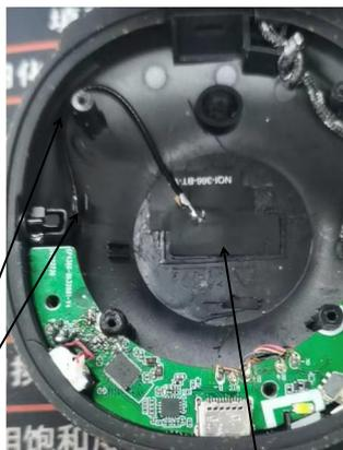
同轴线沿螺柱外放置, 卡扣卡住线
