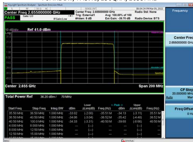
70MHz BW, TM3.1a, 256QAM, 2655MHz
