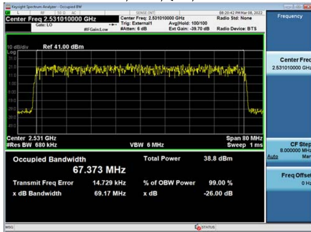
70MHz BW, TM1.1, QPSK, 2531MHz
