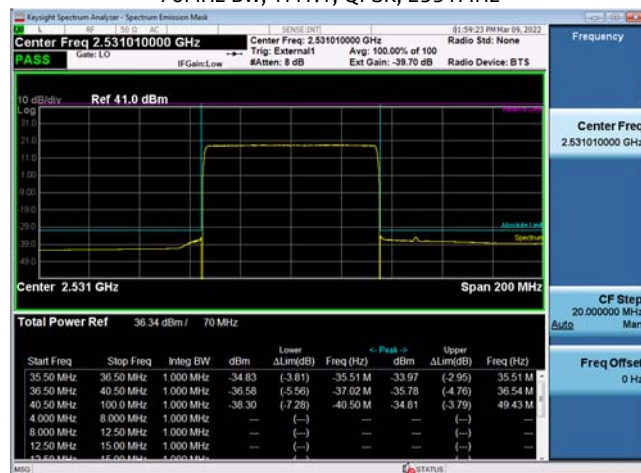
70MHz BW, TM1.1, QPSK, 2531MHz
