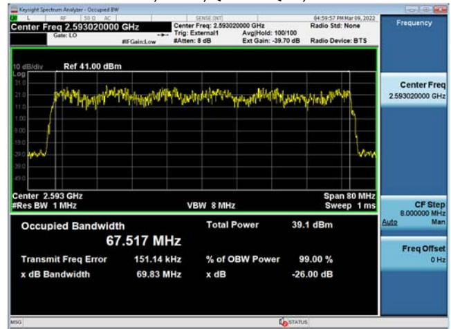
70MHz BW, TM3.2, QPSK/16QAM, 2593MHz
