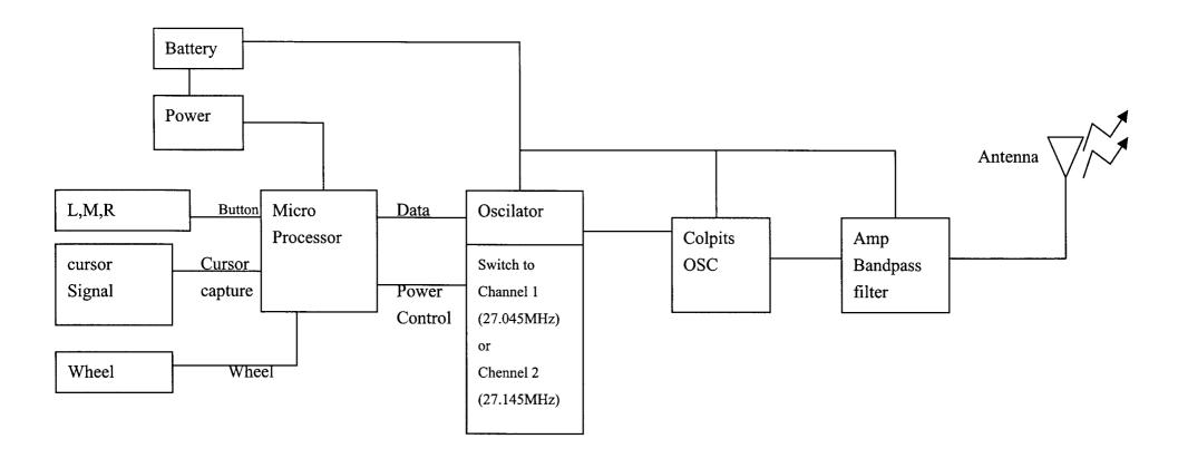
Model: RFSWOP-27 Wireless Radio Wheel Mouse (Transmitter)
