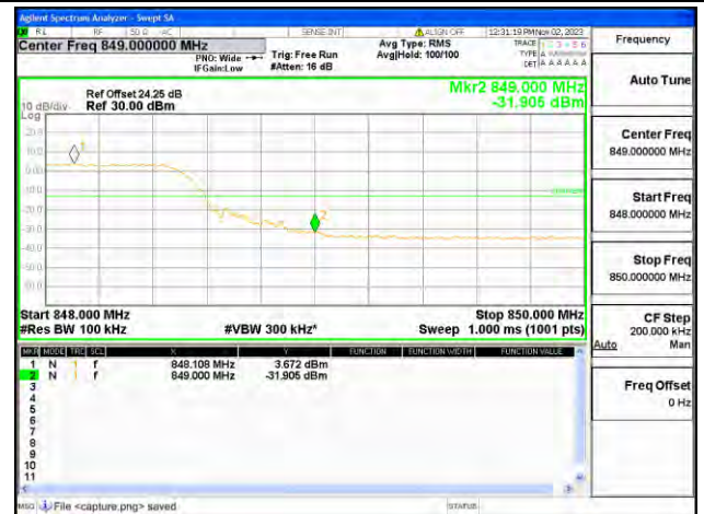
B5 / 10MHz / High CH / QPSK / FULL RB
