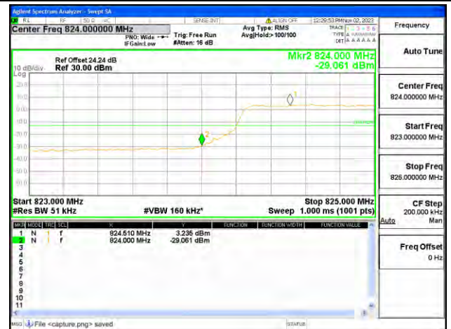
B5 / 5MHz / Low CH / QPSK / FULL RB
