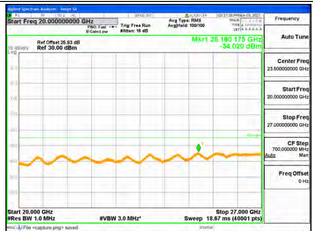
B38-20G-27G / 20MHz / Mid CH / QPSK
