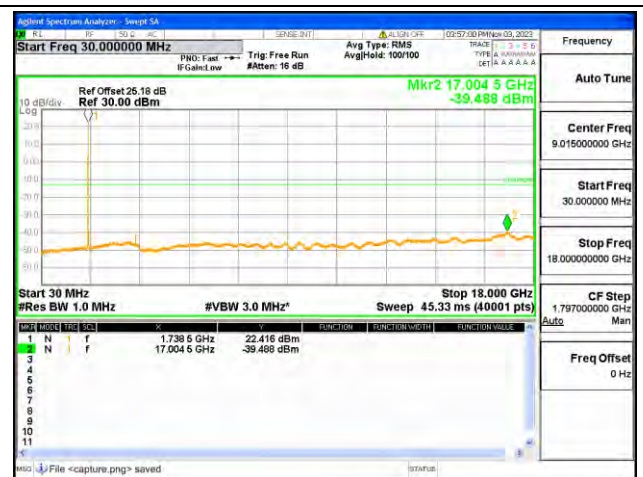
B66 / 15MHz / Mid CH / QPSK
