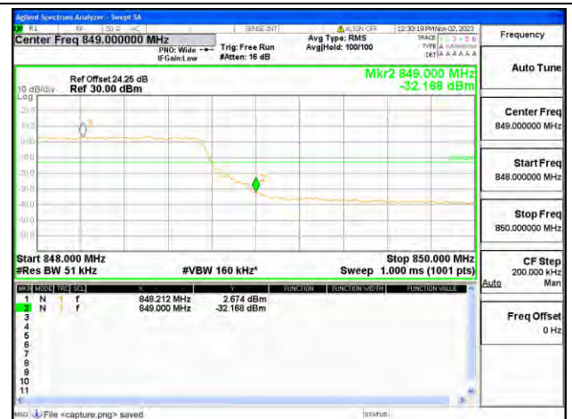
B5 / 5MHz / High CH / QPSK / FULL RB
