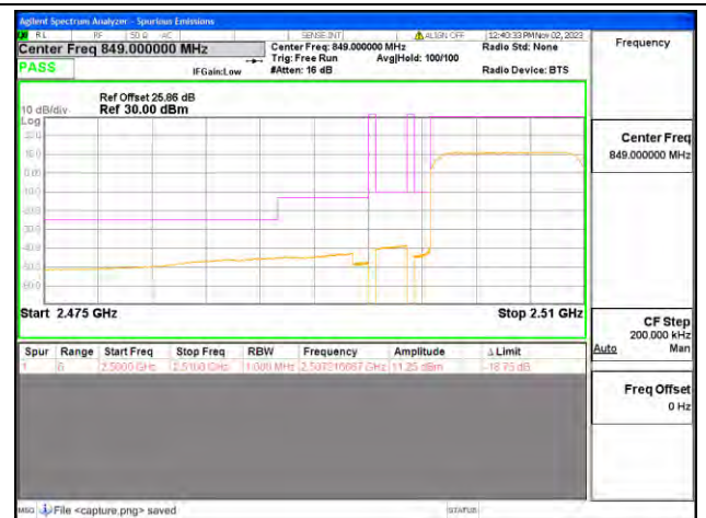
B7 / 10MHz / Low CH / QPSK / FULL RB
