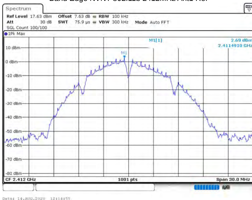
Band Edge NVNT 802.11b 2412MHz Ant1 Ref
