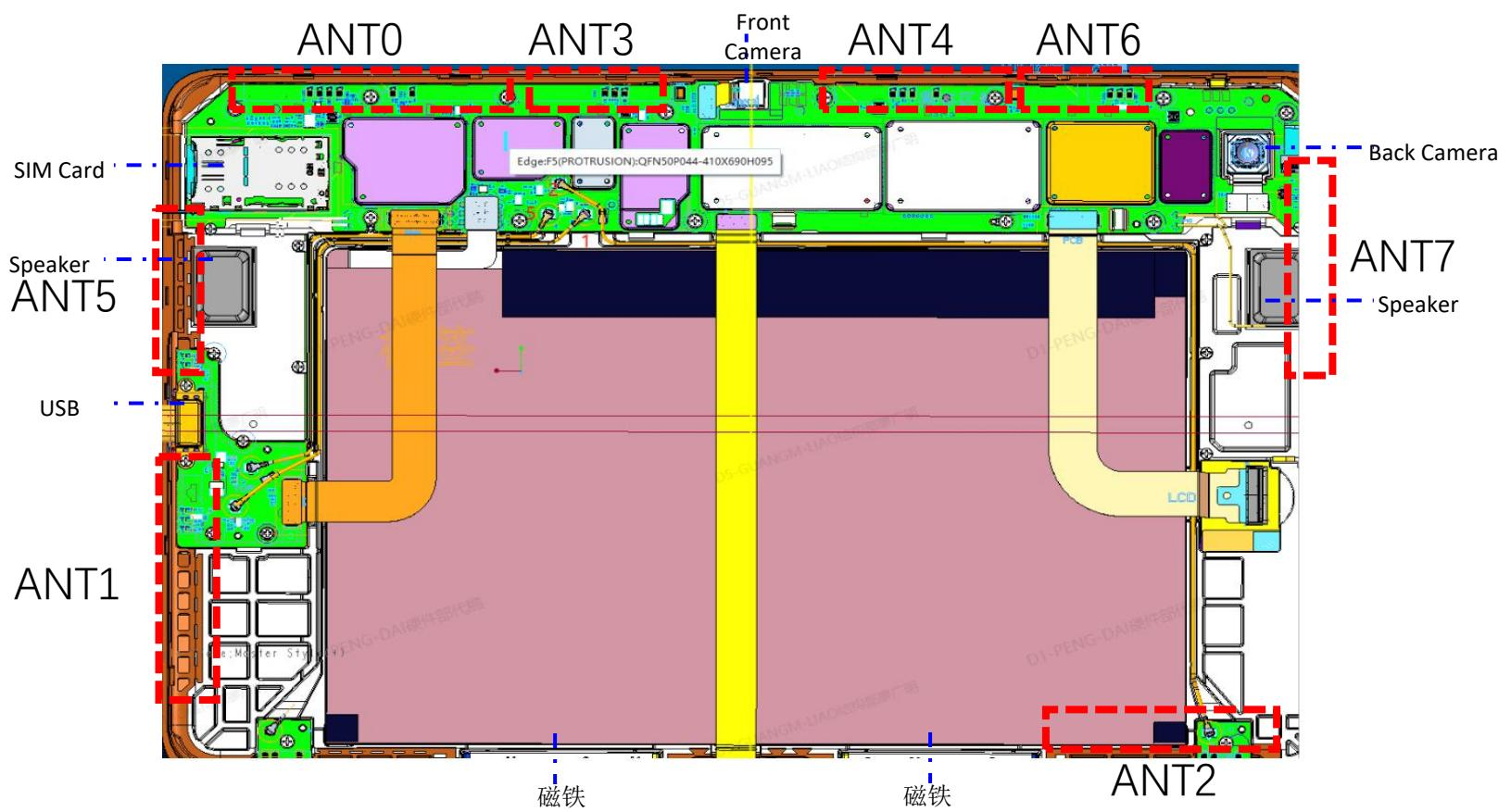
ANT0: LTE B5/7 TRX, GSM 850/1900 TRX, W B2/5 TRX, endc B5 TRX
