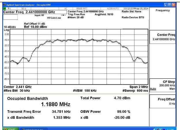
Test Mode:π/4DQPSK(2DH5) 2402MHz
