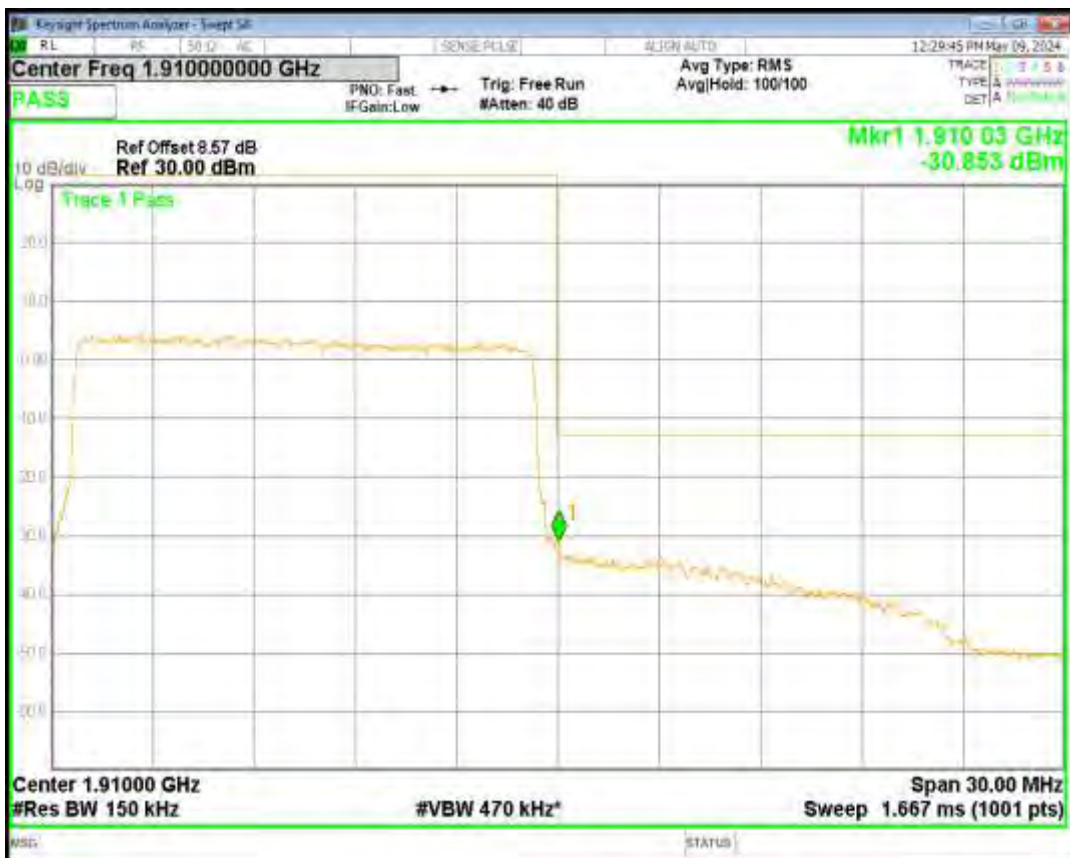
Band2 16QAM BW=20MHz Channel=18700 RB Size=100 Position=#0
