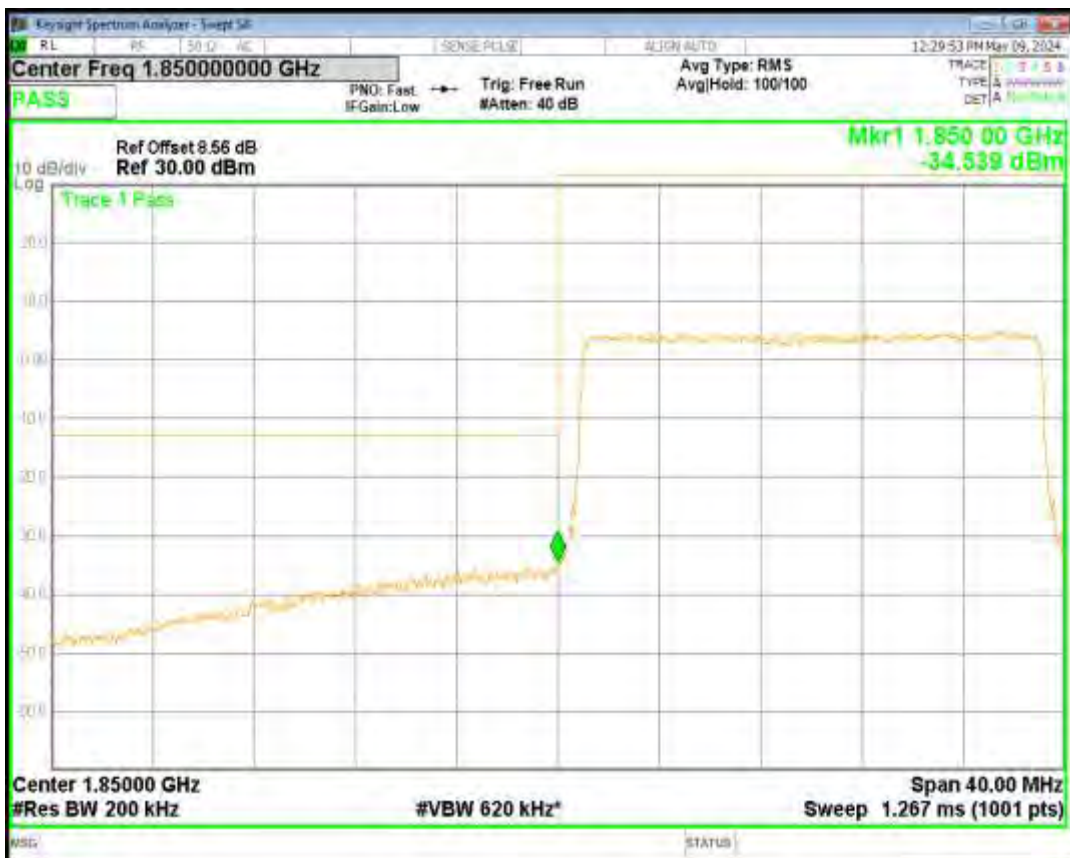
Band2 QPSK BW=20MHz Channel=19100 RB Size=100 Position=#0
