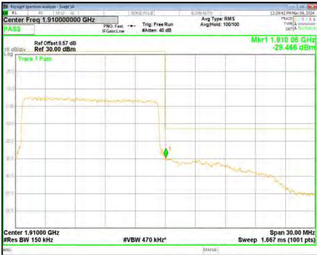
Band2 QPSK BW=20MHz Channel=18700 RB Size=100 Position=#0
