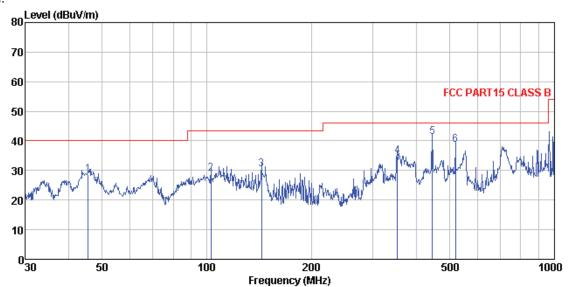
: 3m chamber : FCC PART15 CLASS B 3m VULB9163-2013M VERTICAL : 1404RF
