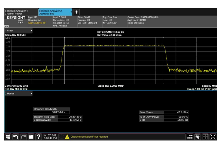
Figure 170: output 256QAM 40MHz B.W.; 2593.0MHz, 15kHz
