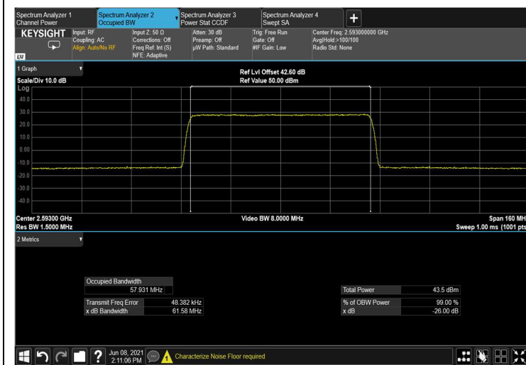
Figure 193: output QPSK 60MHz B.W.; 2593.0MHz, 30kHz
