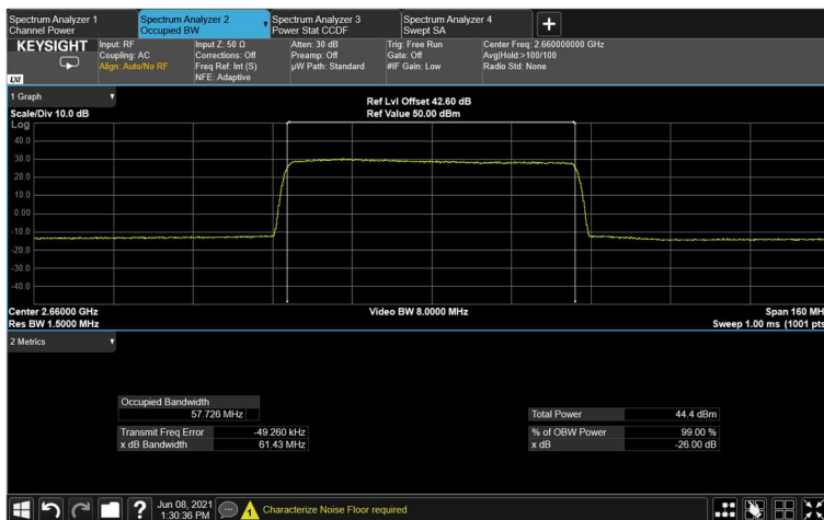
Figure 165: output 64QAM 60MHz B.W.; 2660.0MHz, 30kHz
