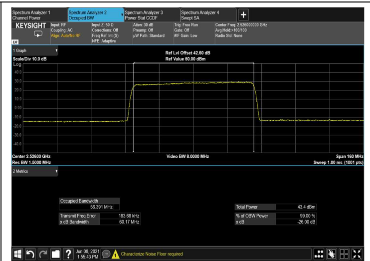
Figure 192: output QPSK 60MHz B.W.; 2526.0MHz, 60kHz
