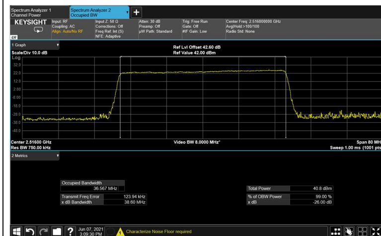
Figure 169: output 256QAM 40MHz B.W.; 2516.0MHz, 60kHz
