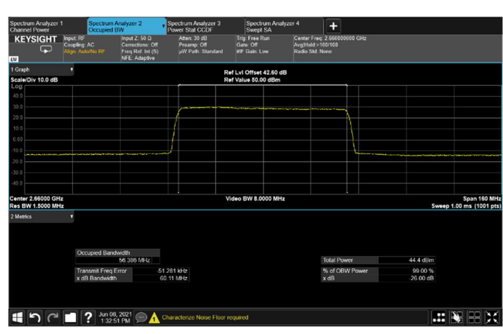
Figure 166: output 64QAM 60MHz B.W.; 2660.0MHz, 60kHz
