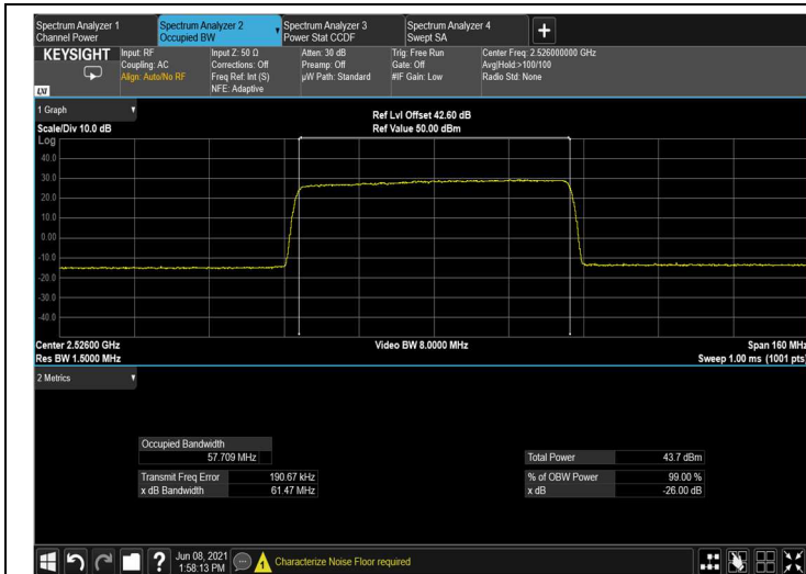
Figure 191: output QPSK 60MHz B.W.; 2526.0MHz, 30kHz
