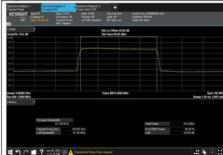
Figure 195: output QPSK 60MHz B.W.; 2660.0MHz, 30kHz
