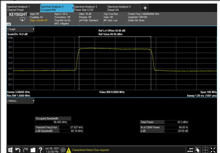
Figure 196: output QPSK 60MHz B.W.; 2660.0MHz, 60kHz
