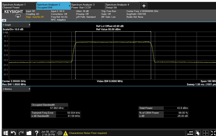
Figure 163: output 64QAM 60MHz B.W.; 2593.0MHz, 30kHz
