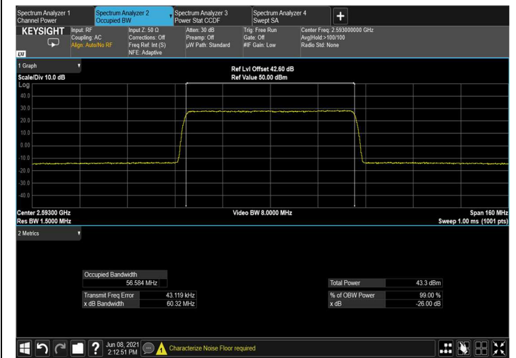
Figure 194: output QPSK 60MHz B.W.; 2593.0MHz, 60kHz
