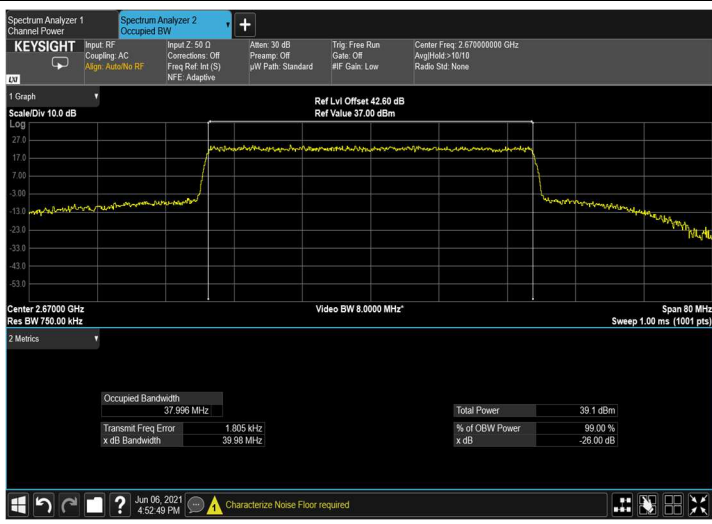
Figure 189: output QPSK 40MHz B.W.; 2670.0MHz, 30kHz
