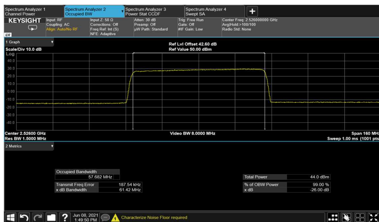
Figure 161: output 64QAM 60MHz B.W.; 2526.0MHz, 30kHz
