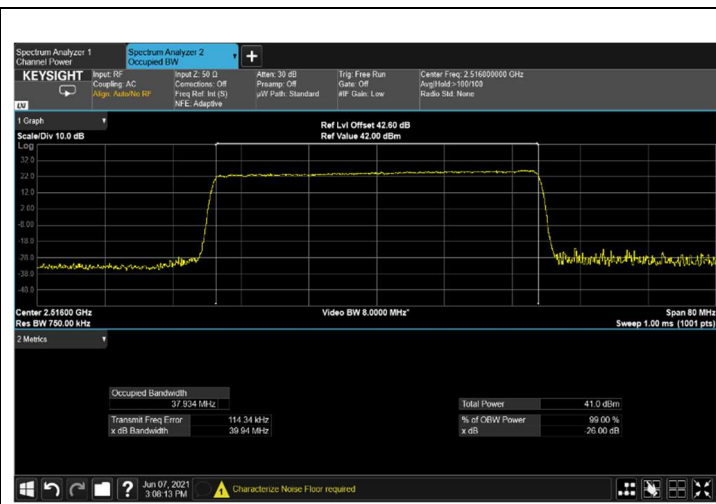
Figure 168: output 256QAM 40MHz B.W.; 2516.0MHz, 30kHz
