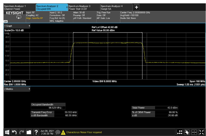
Figure 164: output 64QAM 60MHz B.W.; 2593.0MHz, 60kHz
