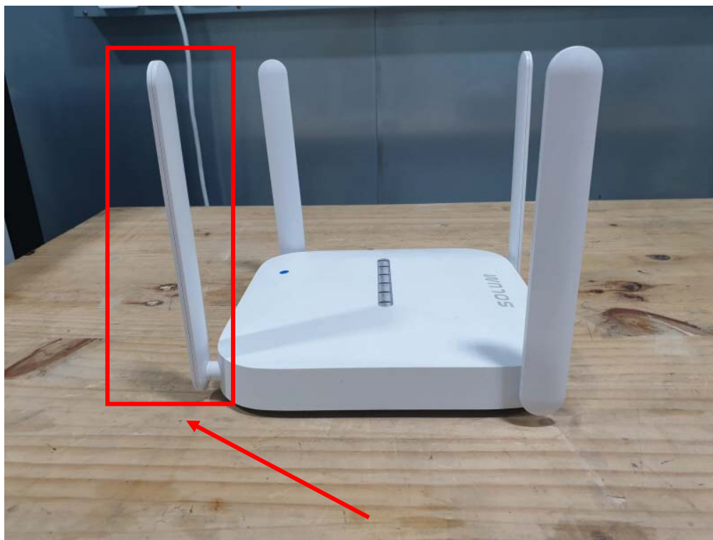
Antenna 1(TX, RX)(Freq : 2402-2480 MHz)
