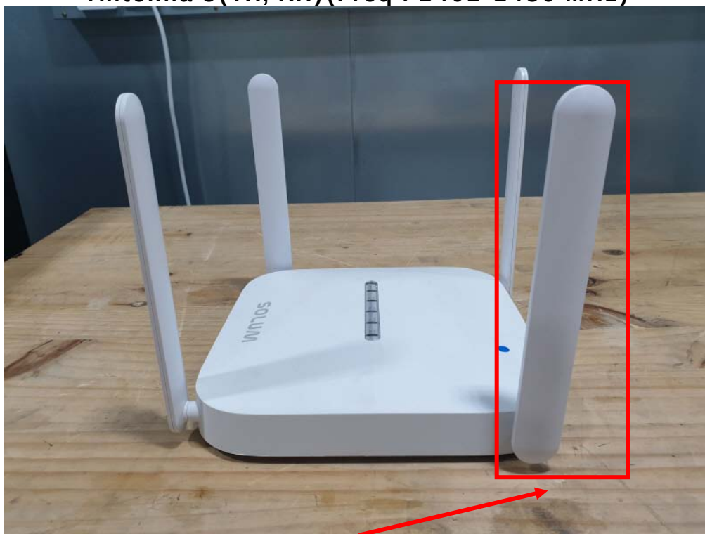
Antenna 4(TX, RX)(Freq : 902.4-927.6 MHz)
