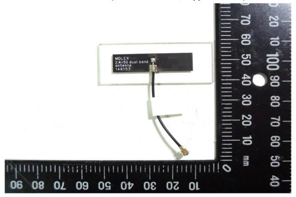
WLAN Antenna (Part No.: H2B1PD1A1C (AA222), Supplier: Unictron)
