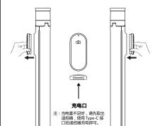
取出運控器 安装遥控器 遥控器采用磁铁吸附,向外取出即可,装回时只需
