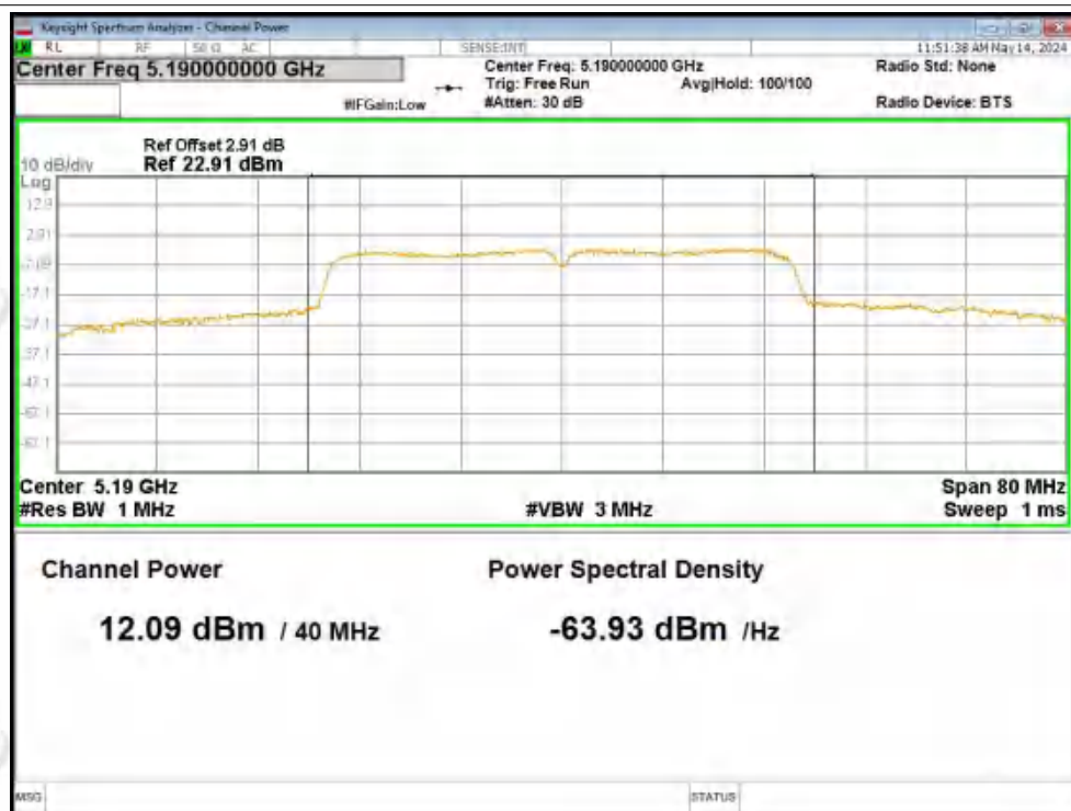
Power NVNT n40 5230MHz Ant1
