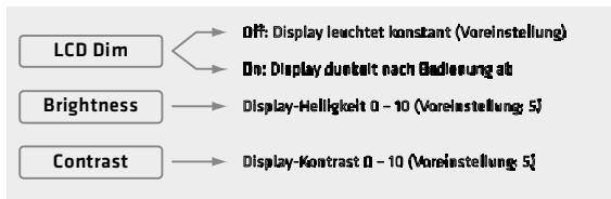
**LCD Dim:** Der Punkt markiert (Off) die aktuelle Helligkeit ist konstanter Helligkeit. Ist die Funktion aktiviert (On), dunkelt sich das Display acht Sekunden nach der letzten Bedienung des Master-Reglers ab, bleibt aber weiterhin gut lesbar. Sobald der Master-Regler bedient wird, leuchtet das Display wieder in der eingestellten Helligkeit.
