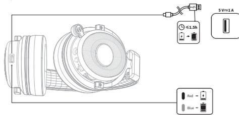
(1) Wenn der Headset-Akku niedrig ist, wird alle 3 Minuten eine Sprachermahnung "Schwache Batterie, bitte aufladen" durchgeführt und das rote Licht blinkt alle 3 Sekunden.
