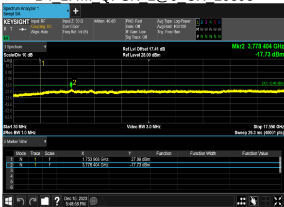
B4 1.4M QPSK 1@0 CH 20393
