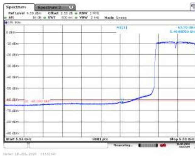
5550MHz with 4*4 Beamforming AV
