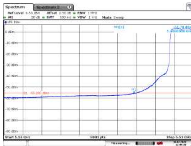
5500MHz with 2*2 Beamforming AV
