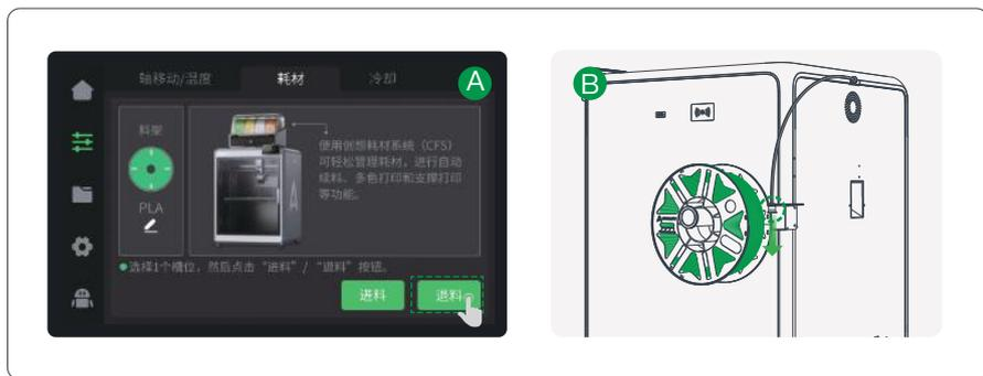
6 退料：A. 在耗材管理页面点击退料，挤出机将会自动移动到左前方切断耗材进行回抽；
