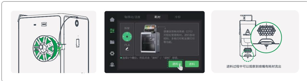
5 进料：用手轻推耗材，并在耗材页面点击进料，机器将会自动设置当前耗材温度，升温完成后将会自动挤出；
