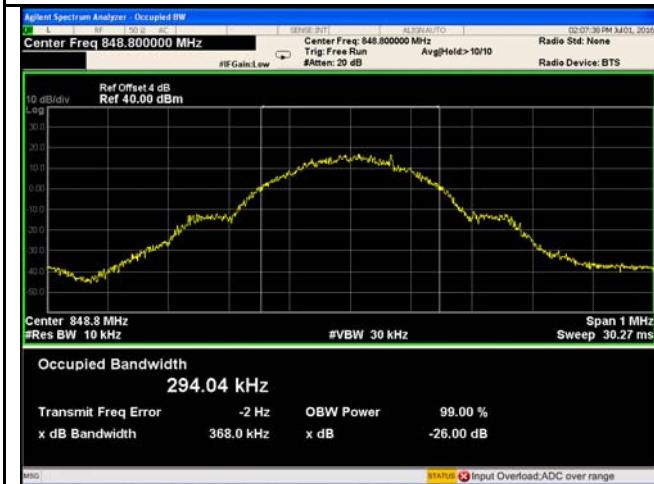
GSM 850 BW - High CH 848.8MHz
