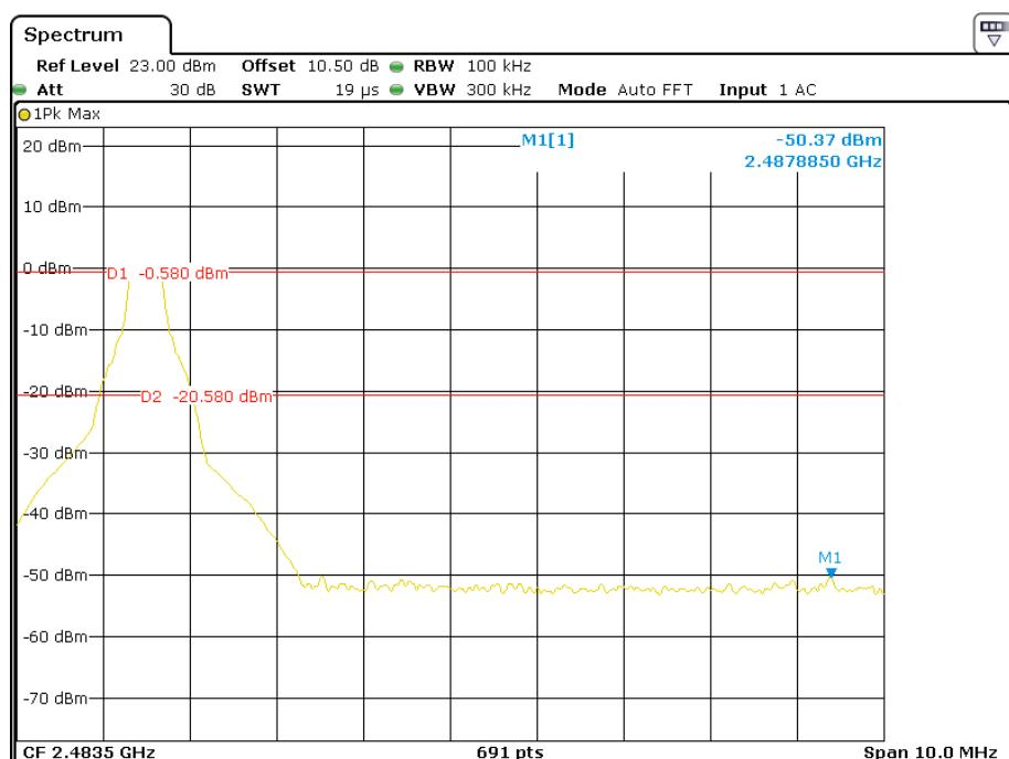
**EDR ( $\pi/4$ -DQPSK): Band Edge-Left Side
