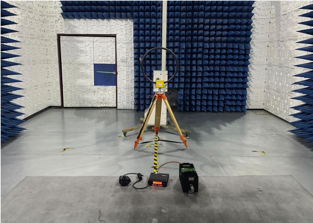
RADIATED EMISSION 30MHz-1GHz TEST SETUP
