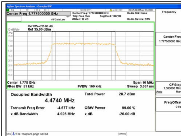
B66 / 5MHz / QPSK/ High CH
