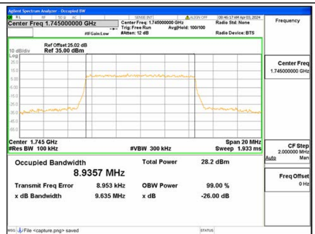
B66 / 10MHz / 16QAM / Mid CH
