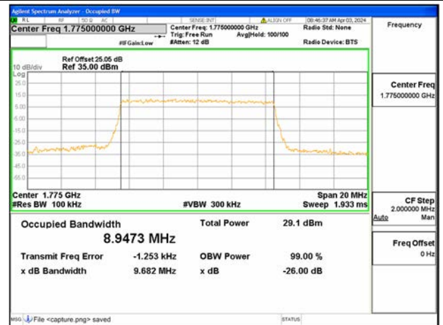
B66 / 10MHz / QPSK / High CH
