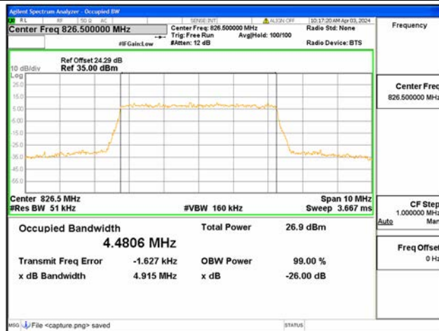
B5 / 5MHz / 64QAM/ Low CH
