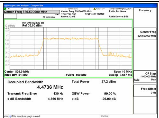
B5 / 5MHz / 16QAM/ Low CH
