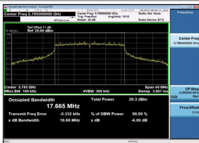
U-NII-3 6dB Bandwidth-802.11ac(40MHz) ,5755MHz,Ant0
