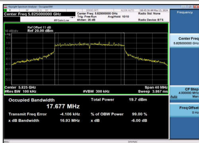
U-NII-3 6dB Bandwidth-802.11ac(20MHz) ,5825MHz,Ant0
