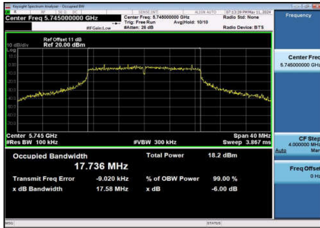
U-NII-3 6dB Bandwidth-802.11n(20MHz) ,5825MHz,Ant0
