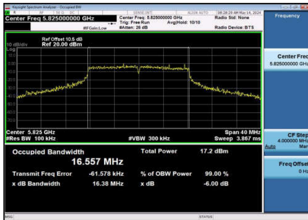
U-NII-3 6dB Bandwidth-802.11n(40MHz) ,5795MHz,Ant0
