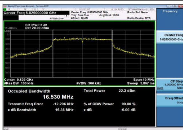
U-NII-3 6dB Bandwidth-802.11ac(20MHz) ,5785MHz,Ant0
