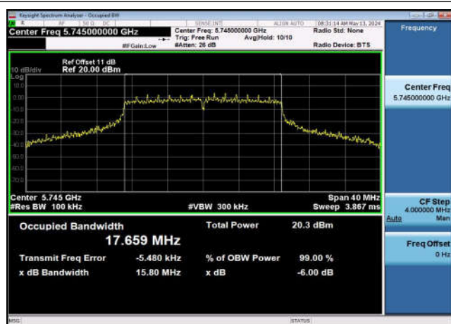
U-NII-3 6dB Bandwidth-802.11ac(20MHz) ,5825MHz,Ant0
