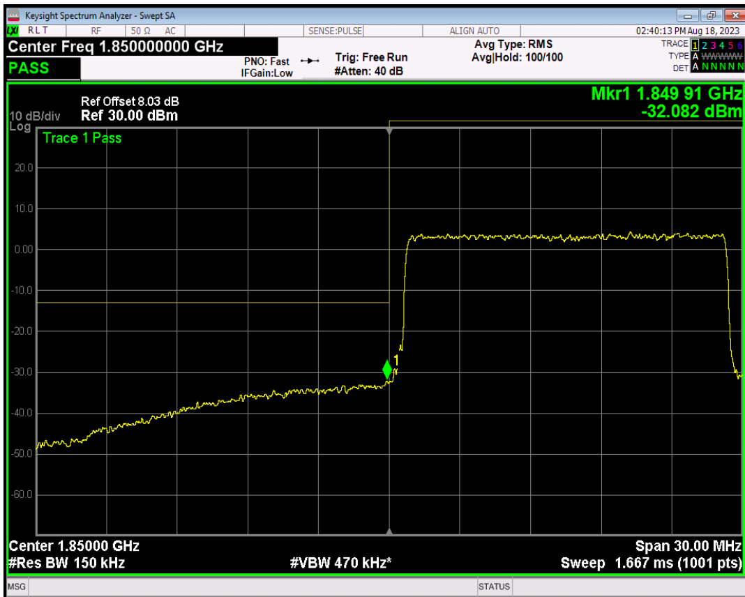
Band2 QPSK BW=15MHz Channel=19125 RB Size=1 Position=#0
