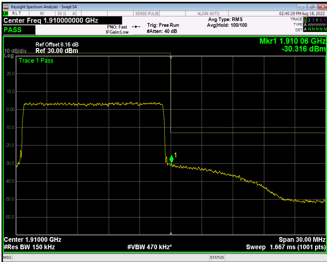
Band2 QPSK BW=20MHz Channel=18700 RB Size=1 Position=#0
