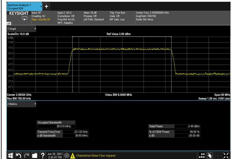
Figure 126: input QPSK 40MHz B.W.; 2593.0MHz, 30kHz
