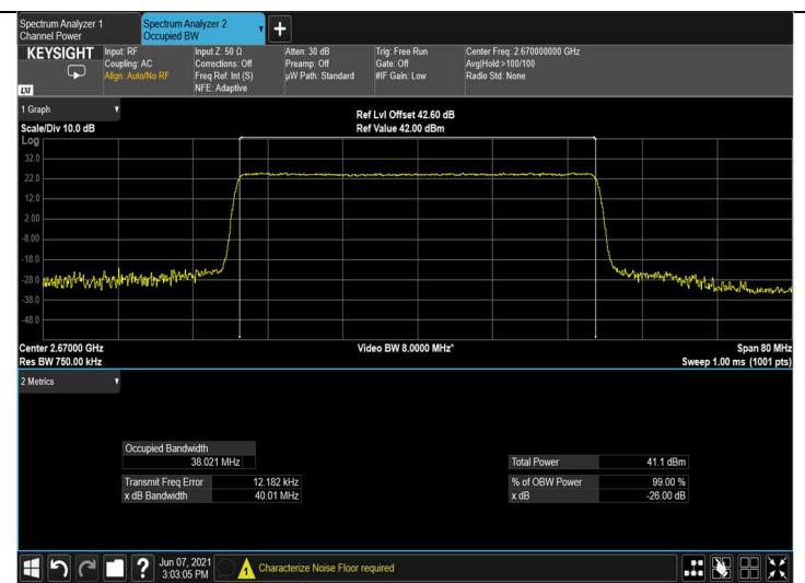
Figure 114: input 256QAM 40MHz B.W.; 2670.0MHz, 30kHz
