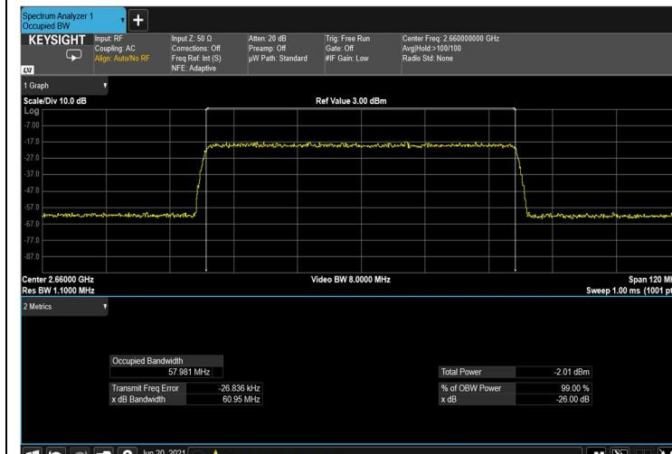
Figure 135: input QPSK 60MHz B.W.; 2660.0MHz, 30kHz
