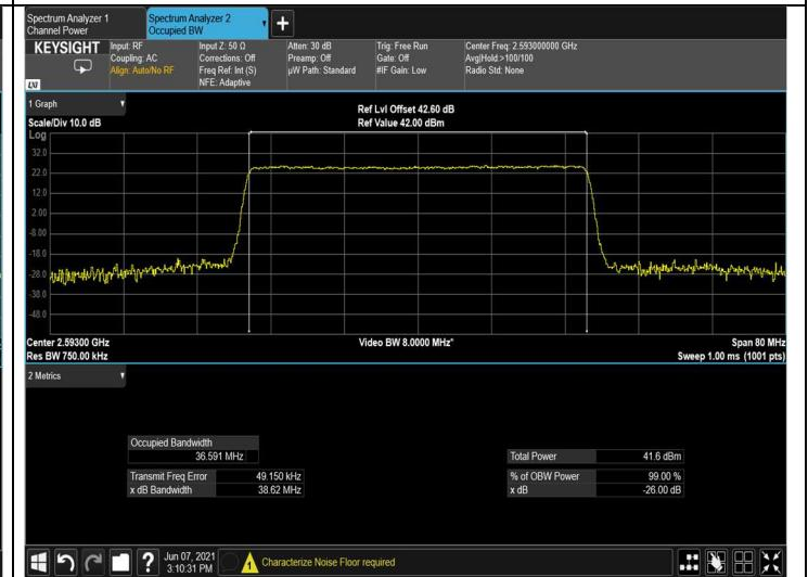
Figure 112: input 256QAM 40MHz B.W.; 2593.0MHz, 60kHz
