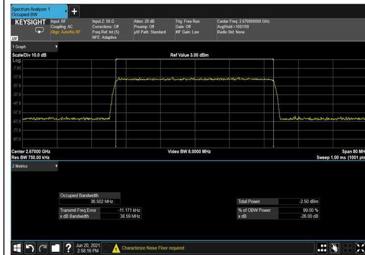
Figure 130: input QPSK 40MHz B.W.; 2670.0MHz, 60kHz
