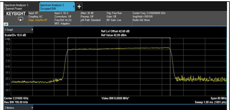
Figure 108: input 256QAM 40MHz B.W.; 2516.0MHz, 30kHz
