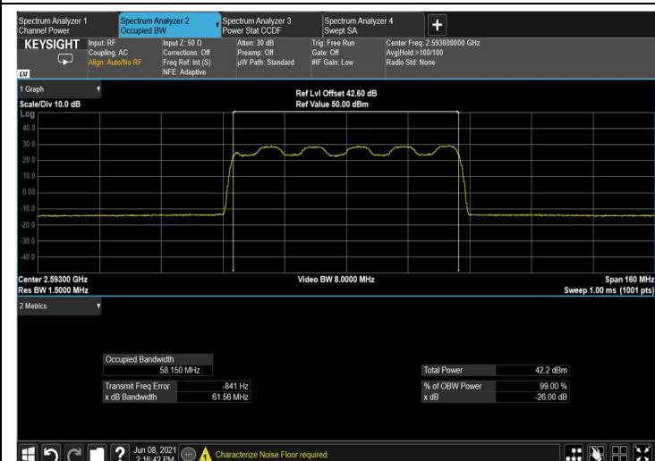
Figure 148: output 16QAM 60MHz B.W.; 2593.0MHz, 30kHz
