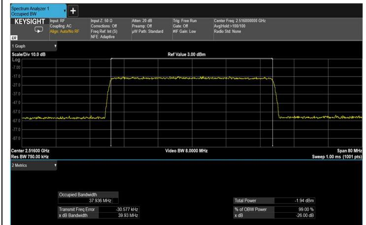
Figure 122: input QPSK 40MHz B.W.; 2516.0MHz, 15kHz
