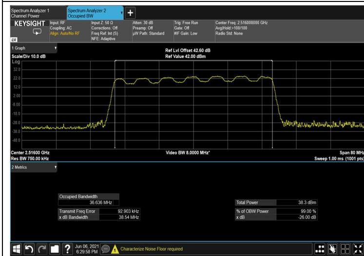
**Figure 139: output 16QAM 40MHz B.W.; 2516.0MHz, 60kHz**
