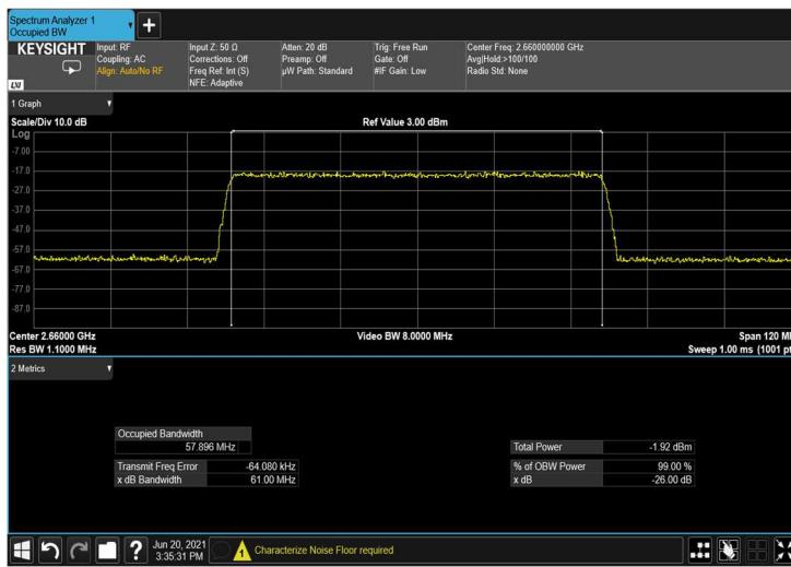
Figure 120: input 256QAM 60MHz B.W.; 2660.0MHz, 30kHz
