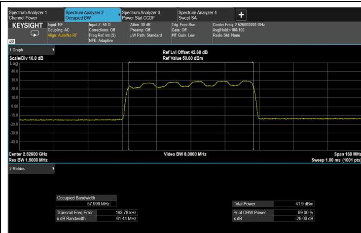
Figure 146: output 16QAM 60MHz B.W.; 2526.0MHz, 30kHz
