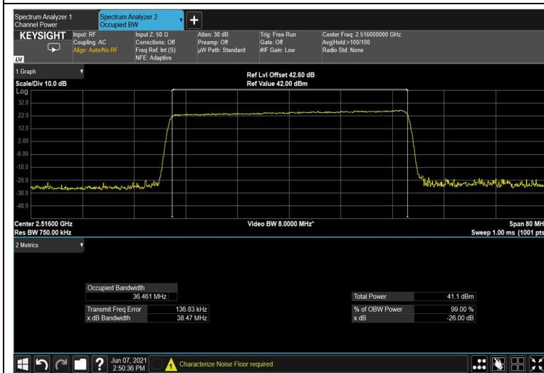
**Figure 154: output 64QAM 40MHz B.W.; 2516.0MHz, 60kHz**
