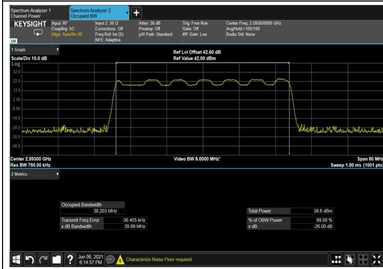
**Figure 141: output 16QAM 40MHz B.W.; 2593.0MHz, 30kHz**
