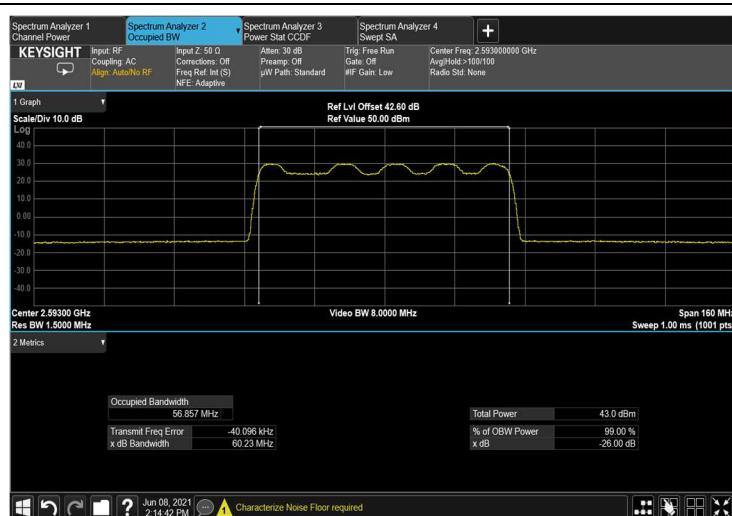
Figure 149: output 16QAM 60MHz B.W.; 2593.0MHz, 60kHz
