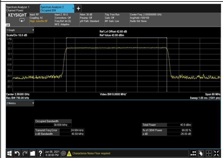
**Figure 155: output 64QAM 40MHz B.W.; 2593.0MHz, 15kHz**
