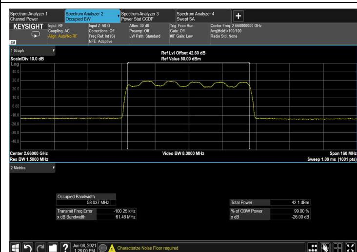
Figure 150: output 16QAM 60MHz B.W.; 2660.0MHz, 30kHz
