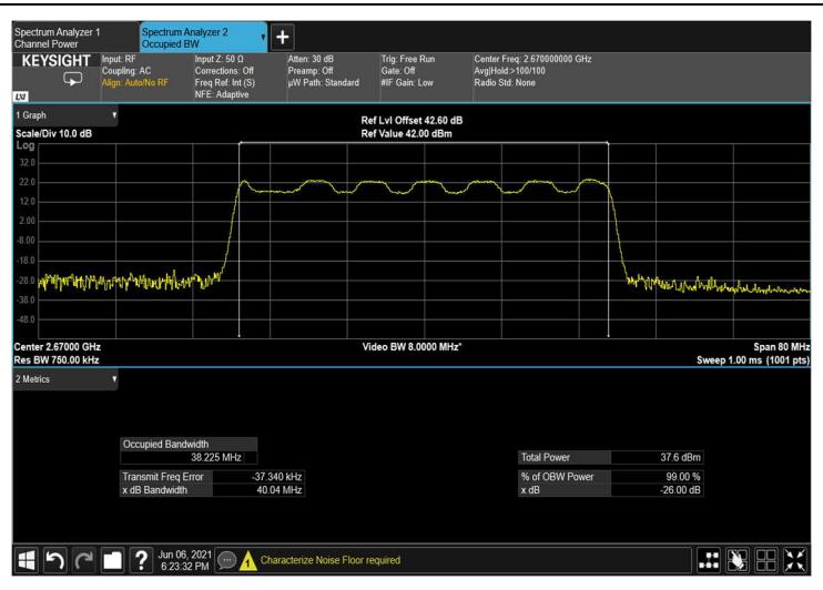
**Figure 144: output 16QAM 40MHz B.W.; 2670.0MHz, 30kHz**
