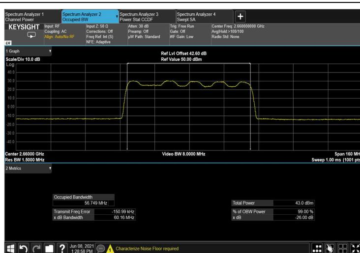
Figure 151: output 16QAM 60MHz B.W.; 2660.0MHz, 60kHz
