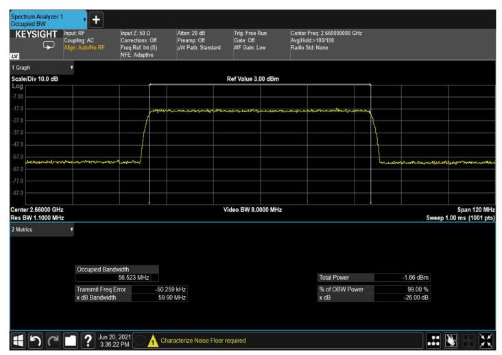
Figure 121: input 256QAM 60MHz B.W.; 2660.0MHz, 60kHz
