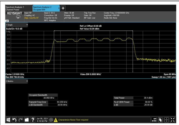
**Figure 138: output 16QAM 40MHz B.W.; 2516.0MHz, 30kHz**
