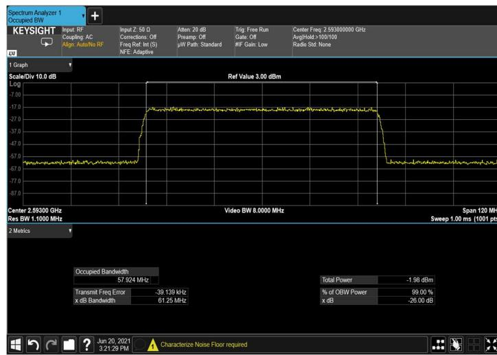
Figure 118: input 256QAM 60MHz B.W.; 2593.0MHz, 30kHz
