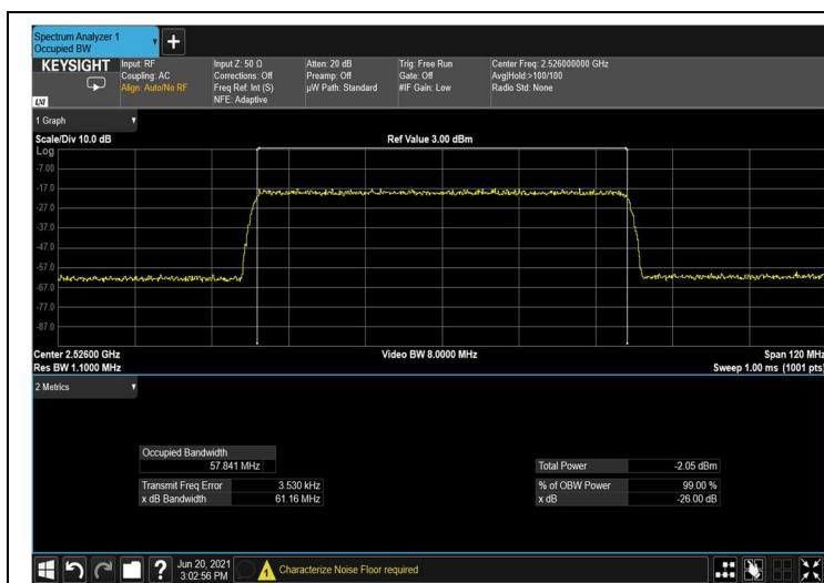
Figure 131: input QPSK 60MHz B.W.; 2526.0MHz, 30kHz
