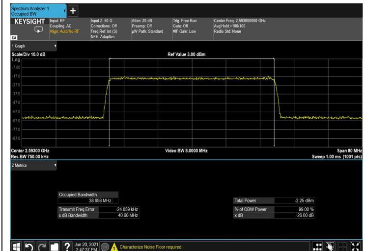
Figure 124: input QPSK 40MHz B.W.; 2516.0MHz, 60kHz
