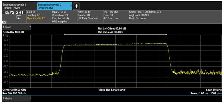
Figure 107: input 256QAM 40MHz B.W.; 2516.0MHz, 15kHz
