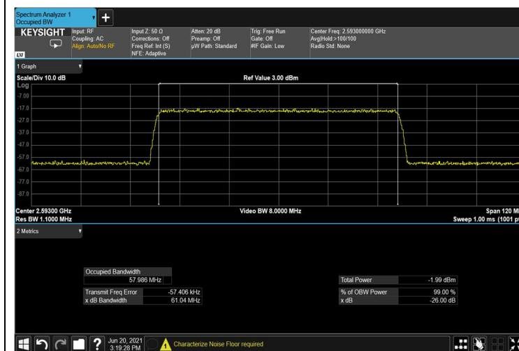
Figure 133: input QPSK 60MHz B.W.; 2593.0MHz, 30kHz
