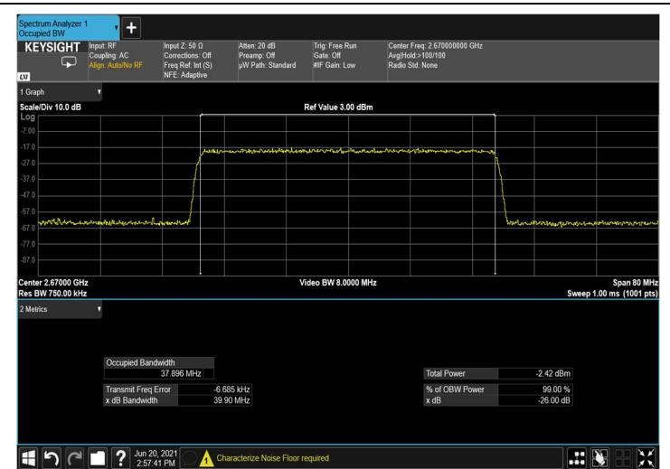
Figure 128: input QPSK 40MHz B.W.; 2670.0MHz, 15kHz
