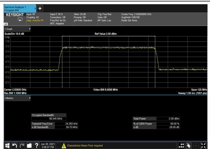
Figure 117: input 256QAM 60MHz B.W.; 2526.0MHz, 60kHz
