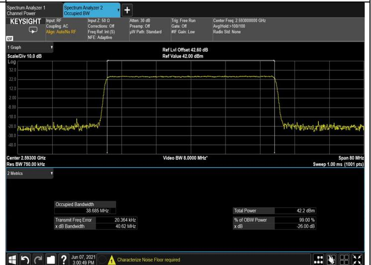
Figure 110: input 256QAM 40MHz B.W.; 2593.0MHz, 15kHz
