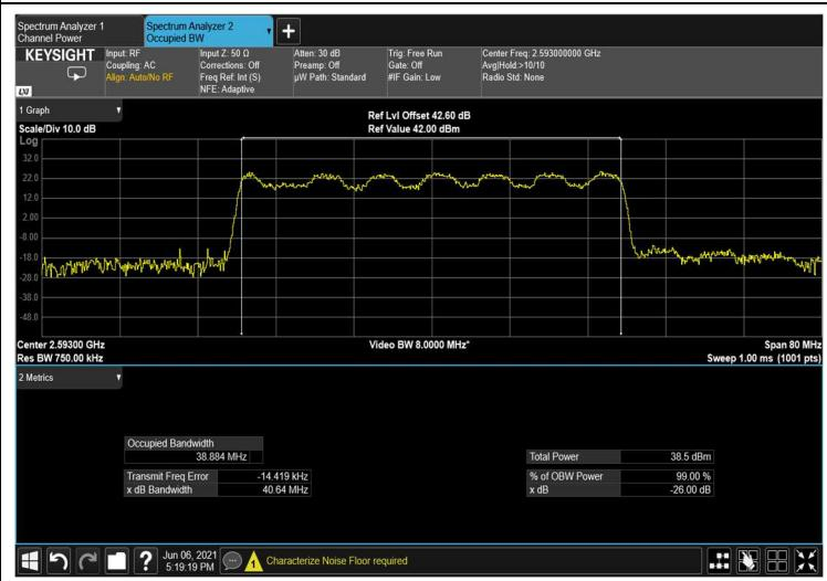
**Figure 140: output 16QAM 40MHz B.W.; 2593.0MHz, 15kHz**
