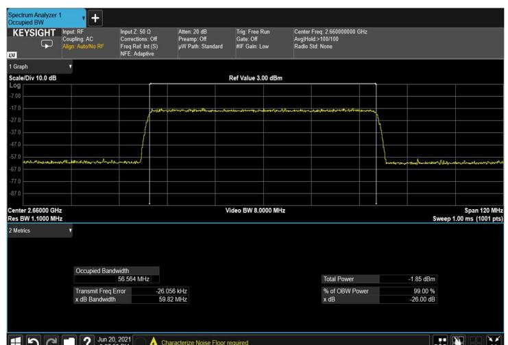
Figure 136: input QPSK 60MHz B.W.; 2660.0MHz, 60kHz
