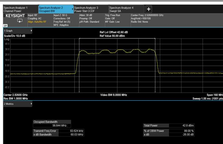
Figure 147: output 16QAM 60MHz B.W.; 2526.0MHz, 60kHz
