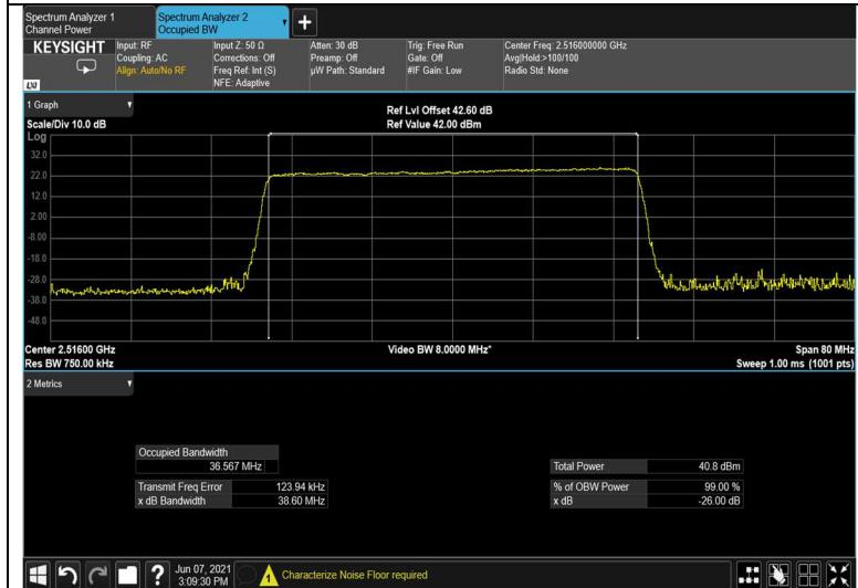
Figure 109: input 256QAM 40MHz B.W.; 2516.0MHz, 60kHz
