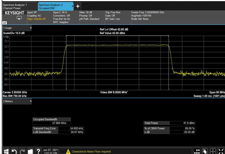
Figure 111: input 256QAM 40MHz B.W.; 2593.0MHz, 30kHz
