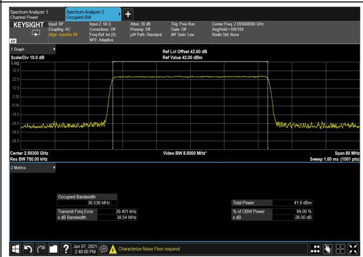
**Figure 157: output 64QAM 40MHz B.W.; 2593.0MHz, 60kHz**
