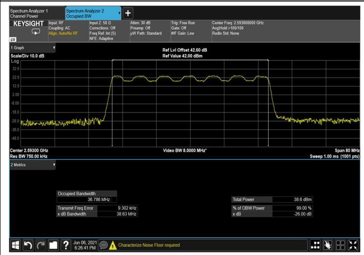
**Figure 142: output 16QAM 40MHz B.W.; 2593.0MHz, 60kHz**
