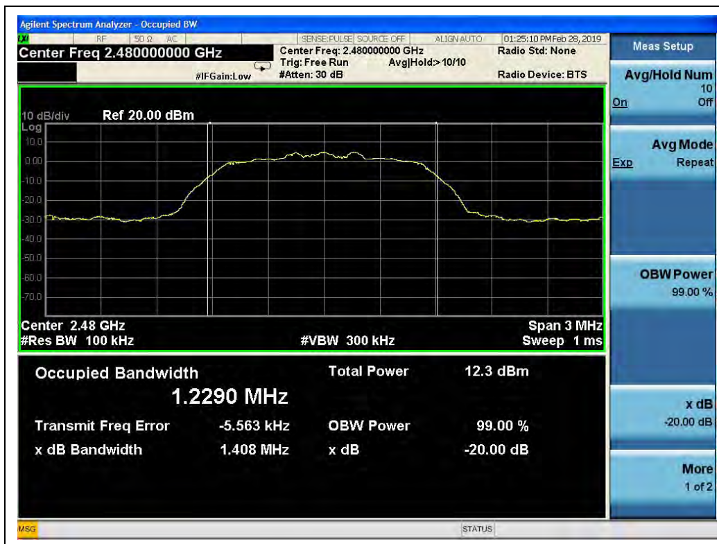
( \pi/4 -DQPSK, Channel 78, 2480MHz)
