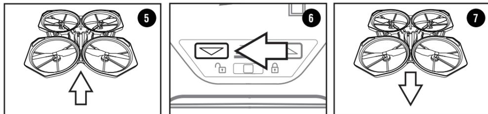
**NOTE: HEIGHT LOCK HAS A MAXIMUM FLIGHT HEIGHT OF APPROX. 1.5 M ABOVE A SURFACE.**
