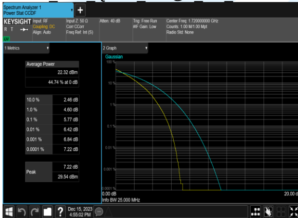
B4 20M QPSK 100@0 CH 20050
