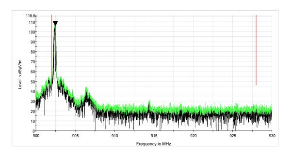
Yagi Antenna: Upper Band Edge - Horizontal
