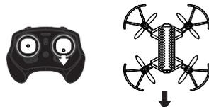
Déplacez le contrôle directionnel vers le bas et le VA-2080 reculera.
