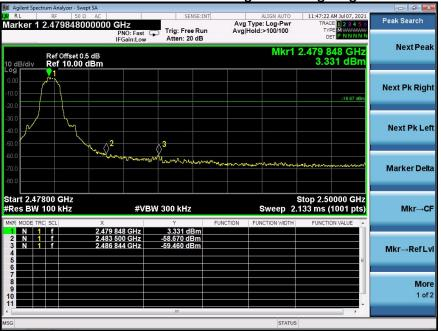
Pi/4 DQPSK Transmitting Band edge-right side
