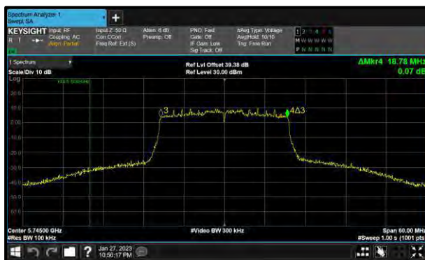
Figure 239 - 802.11ax HE20 SU Minimum 6 dB EBW
