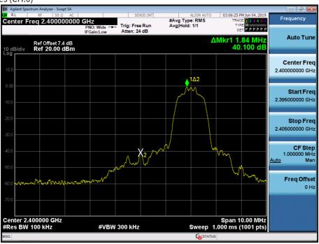
Test Plots without hopping ( $\pi/4DQPSK$ )
