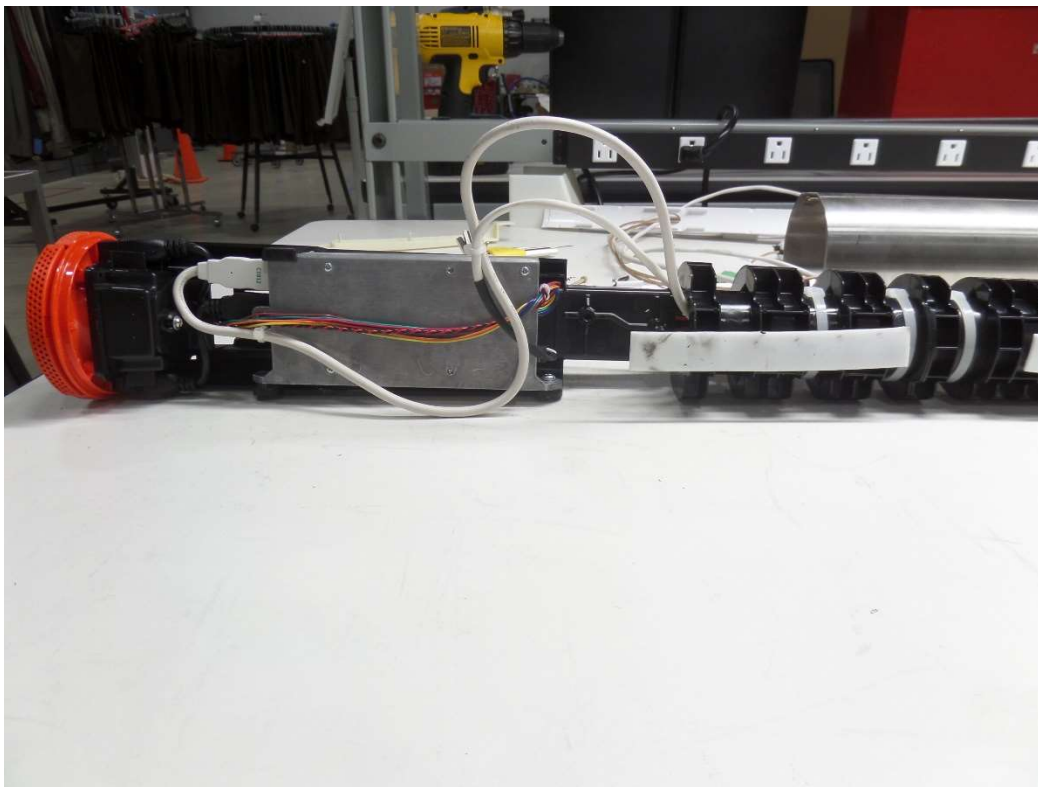
Figure 7: NS40 antenna top section showing SOM module
