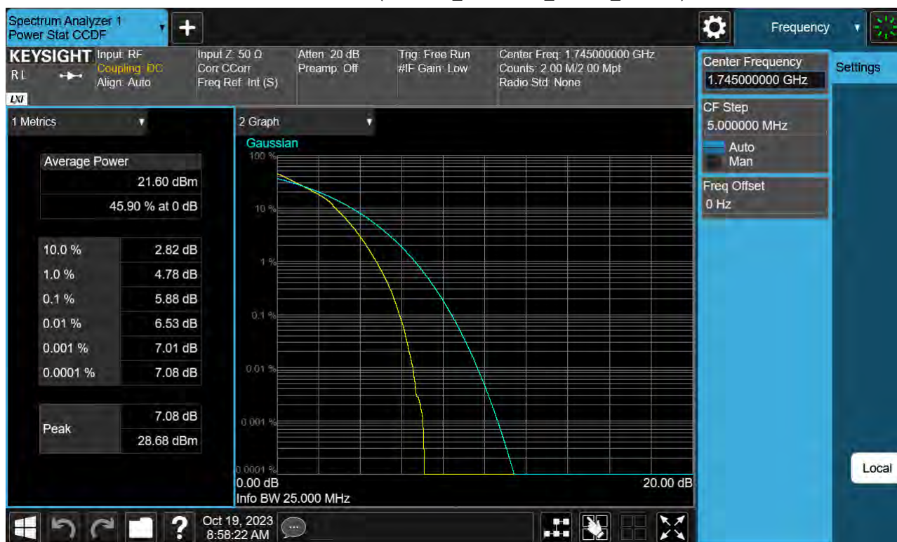
Sub6 n66. PAR Plot (25 M BW_Ch.349000_16QAM_Full RB)
