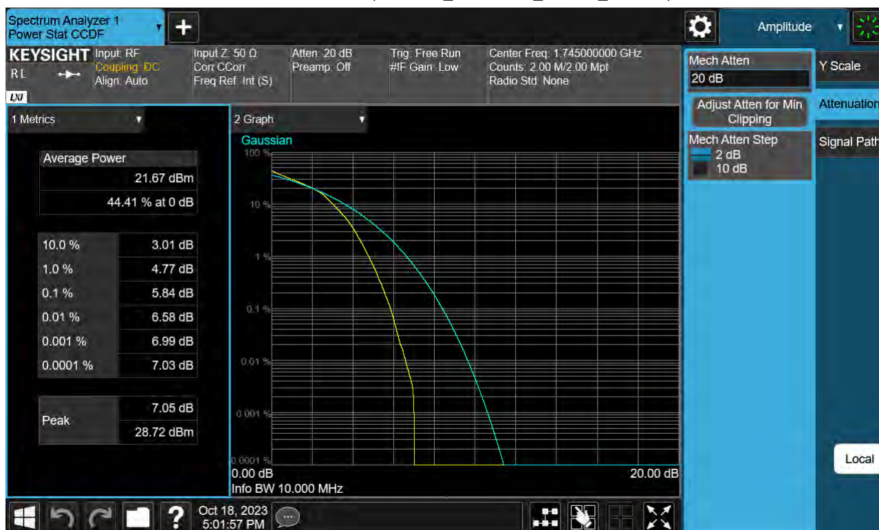
Sub6 n66. PAR Plot (10 M BW_Ch.349000_16QAM_Full RB)
