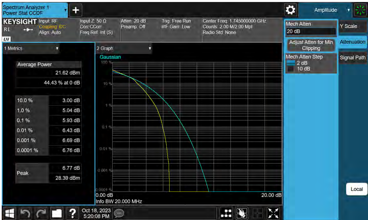
Sub6 n66. PAR Plot (20 M BW_Ch.349000_16QAM_Full RB)
