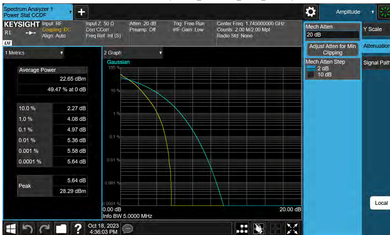
Sub6 n66. PAR Plot (5 M BW_Ch.349000_QPSK_Full RB)
