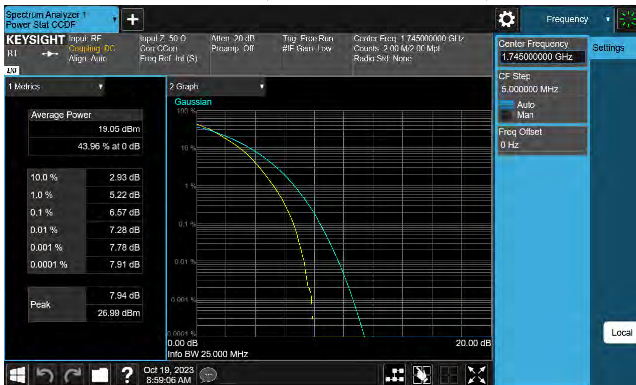
Sub6 n66. PAR Plot (25 M BW_Ch.349000_256QAM_Full RB)
