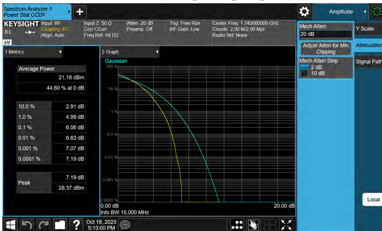
Sub6 n66. PAR Plot (15 M BW_Ch.349000_64QAM_Full RB)
