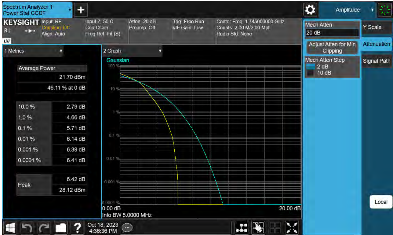
Sub6 n66. PAR Plot (5 M BW_Ch.349000_16QAM_Full RB)
