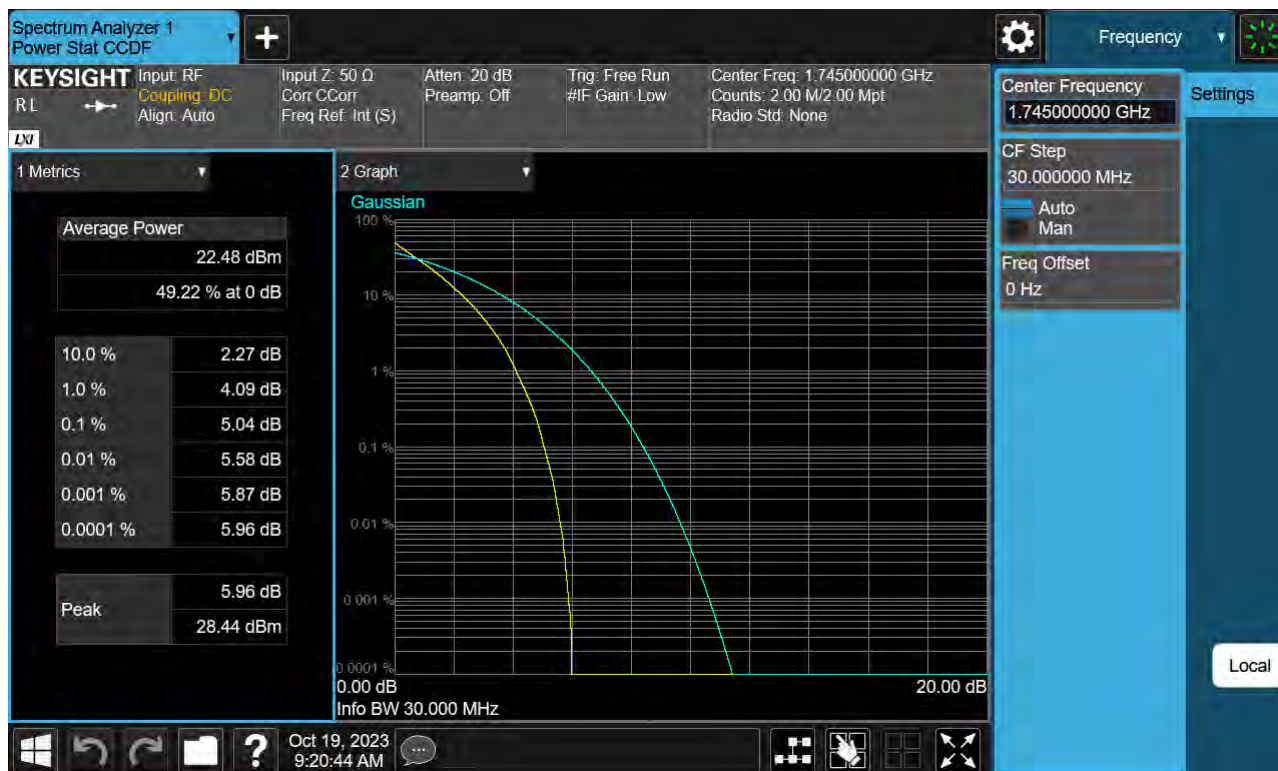
Sub6 n66. PAR Plot (30 M BW_Ch.349000_QPSK_Full RB)
