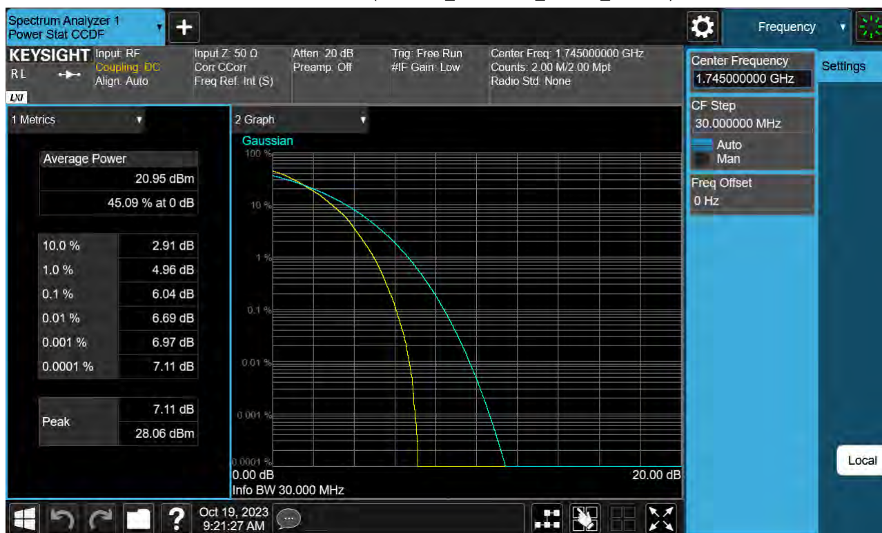
Sub6 n66. PAR Plot (30 M BW_Ch.349000_64QAM_Full RB)
