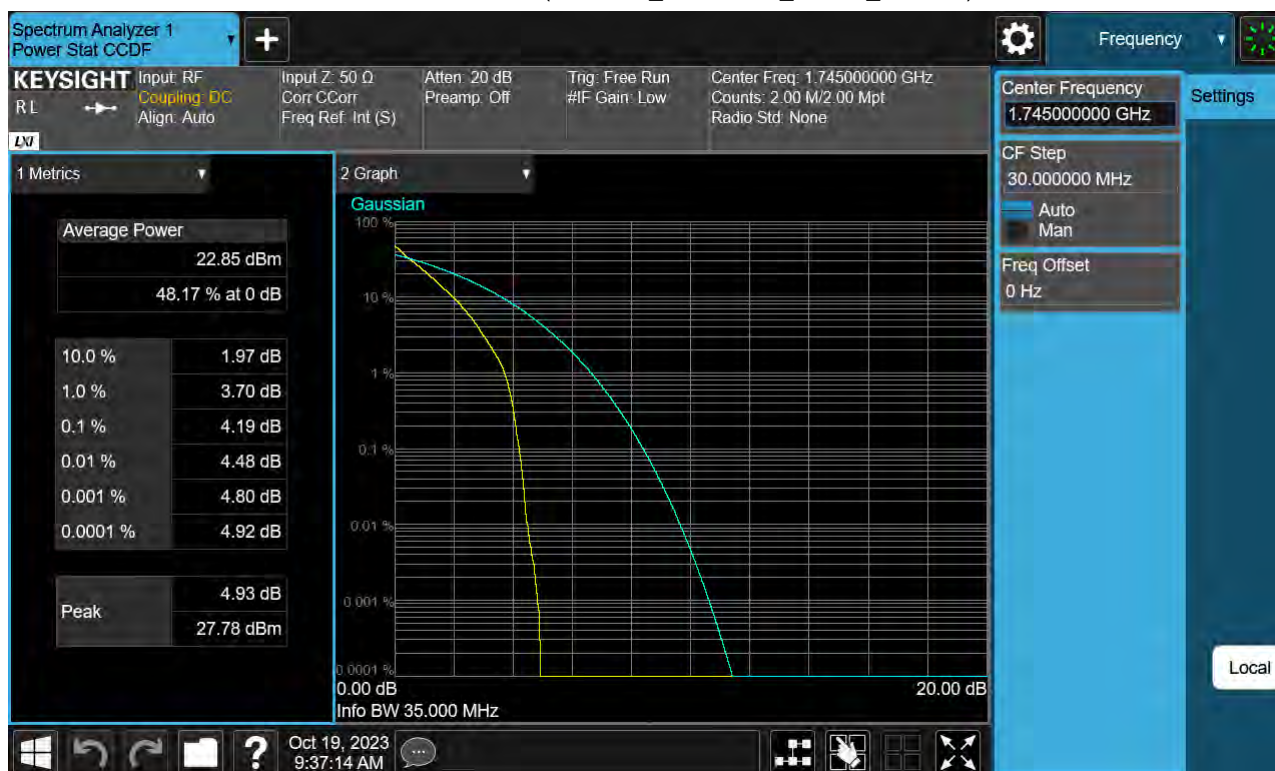
Sub6 n66. PAR Plot (35 M BW_Ch.349000_ BPSK_ Full RB)
