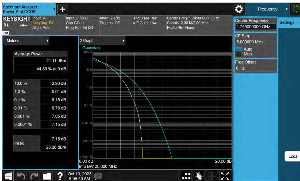
Sub6 n66. PAR Plot (25 M BW_Ch.349000_64QAM_Full RB)
