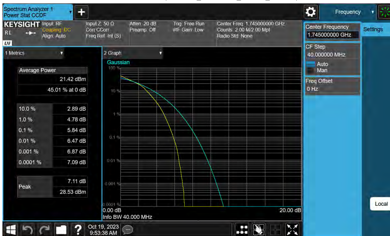
Sub6 n66. PAR Plot (40 M BW_Ch.349000_16QAM_Full RB)
