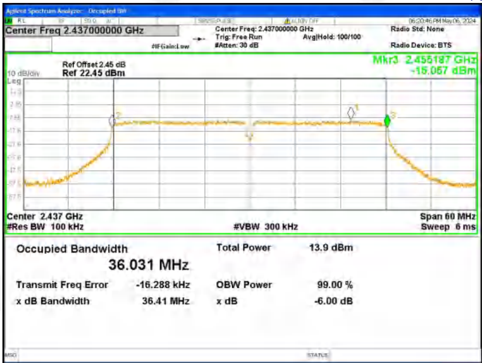
-6dB Bandwidth NVNT n40 2437MHz Ant1
