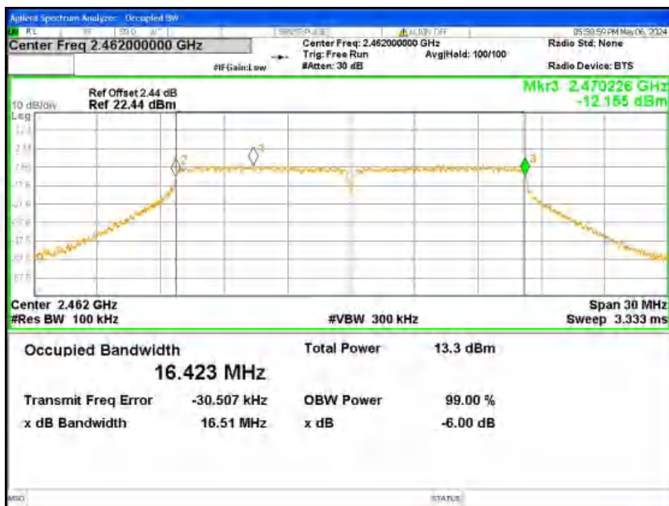
-6dB Bandwidth NVNT g 2462MHz Ant1
