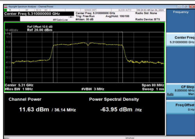
U-NII-2a Output Power-802.11a(20MHz) ,5300MHz,Ant1
