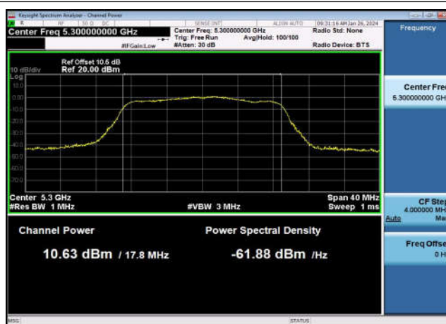
U-NII-2a Output Power-802.11ac(20MHz) ,5300MHz,Ant1
