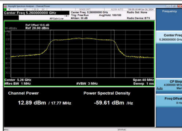
U-NII-2a Output Power-802.11n(20MHz) ,5320MHz,Ant1
