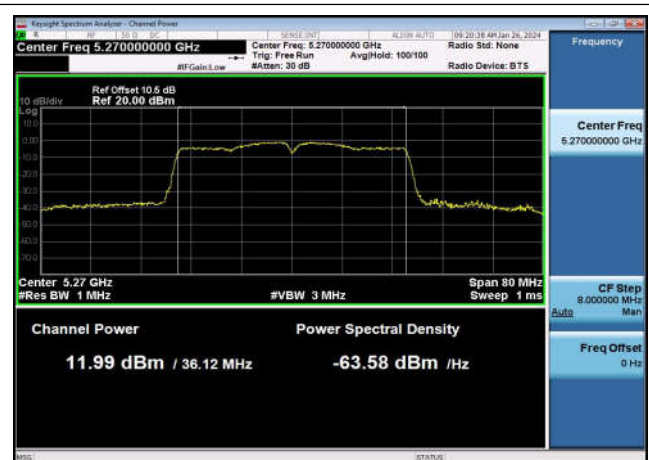
U-NII-2a Output Power-802.11n(40MHz) ,5270MHz,Ant1
