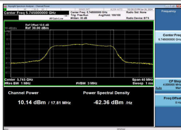
U-NII-3 Output Power-802.11ac(20MHz) ,5745MHz,Ant1
