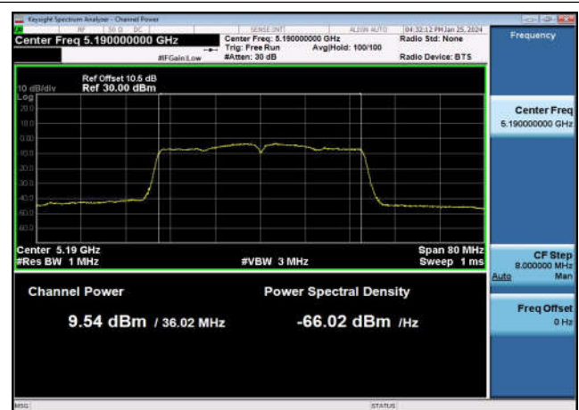
U-NII-1 Output Power-802.11ac(40MHz) ,5190MHz,Ant1
