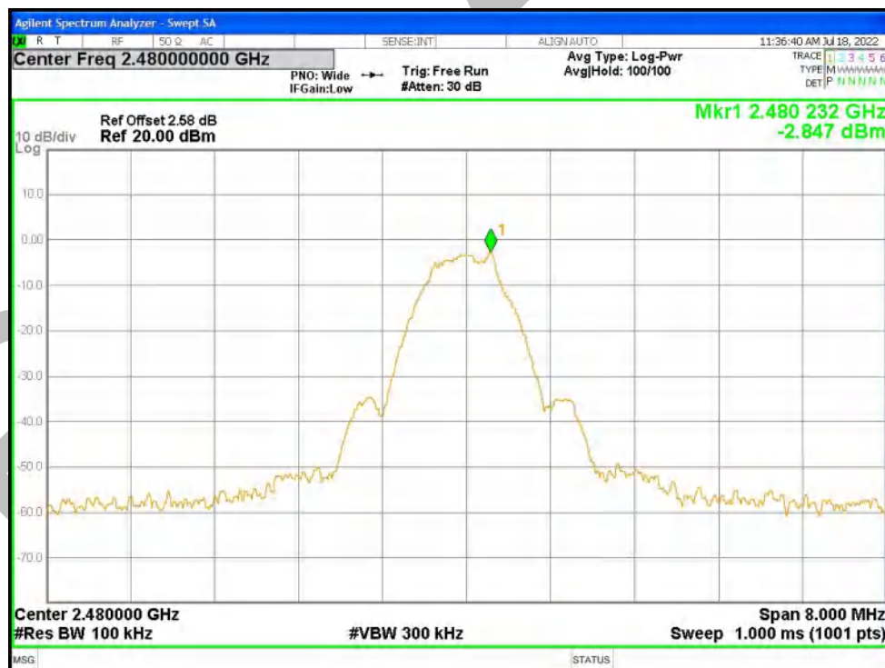
Band Edge NVNT BLE 2480MHz Ant1 Emission
