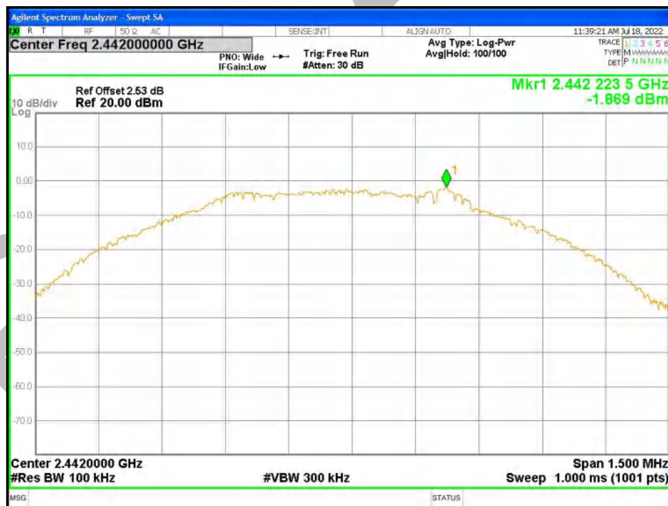
Tx. Spurious NVNT BLE 2442MHz Ant1 Emission
