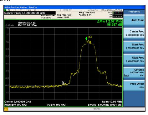
Test Plots without hopping ( $\pi$ /4DQPSK) Band Edges (CH.78)
