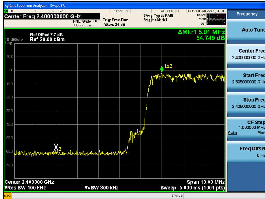
Test Plots with hopping ( $\pi/4$ DQPSK)
