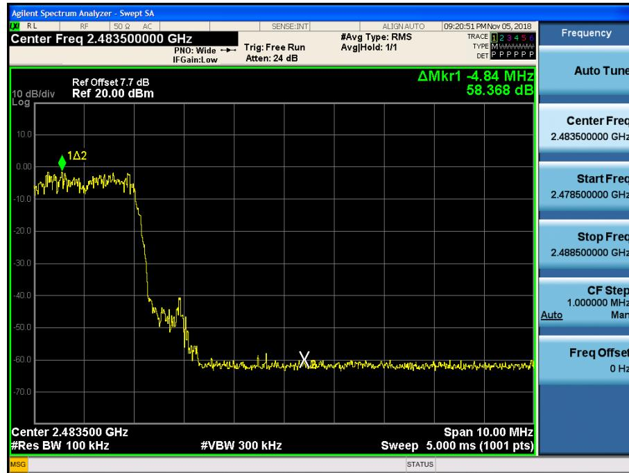
Test Plots with hopping ( $\pi/4$ DQPSK)
