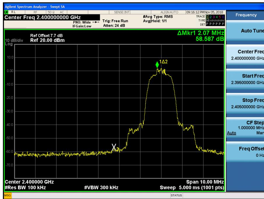
Test Plots without hopping ( $\pi/4$ DQPSK)
