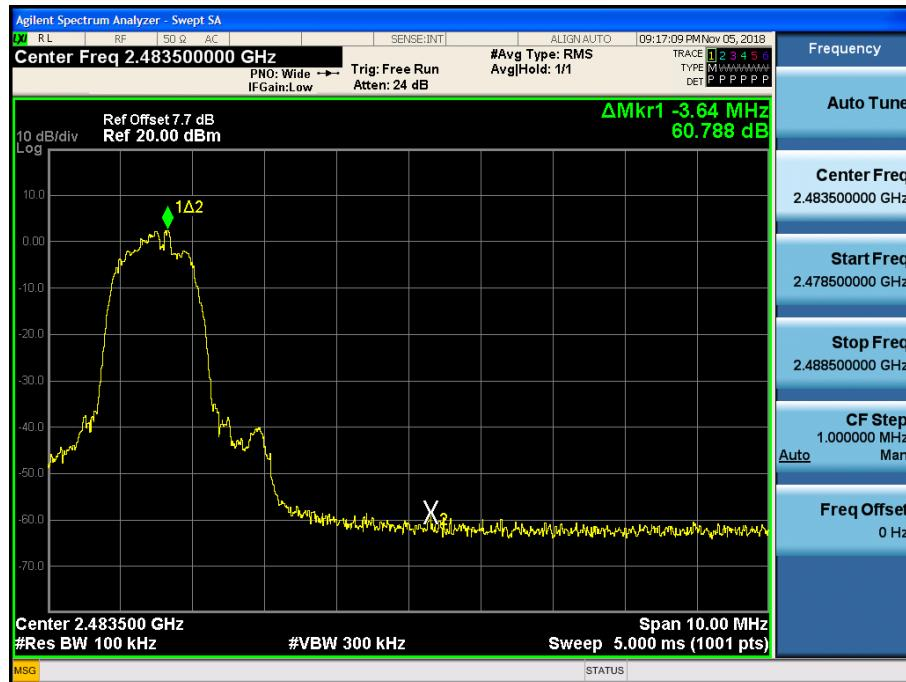
Test Plots without hopping ( $\pi/4$ DQPSK)
