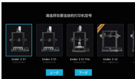
2.7.2 以Ender-3 S1机型为例,选择机型后进入刷机引导页面，请自行准备读卡器及存储卡，用于打印机刷机使用。
