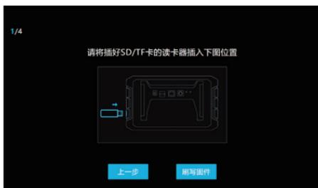
2.7.3 将固件写入SD/TF卡，然后将SD/TF卡插入打印机后，点击下一步。
