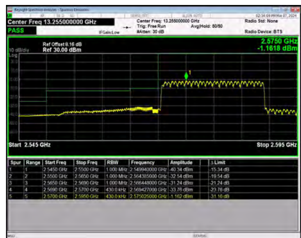
n38 SCS=30kHz DFT_QPSK BW=20MHz LowChannel=516000 RB=50@0
