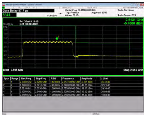
n38 SCS=30kHz DFT_256QAM BW=20MHz HighChannel=522000 RB=50@0
