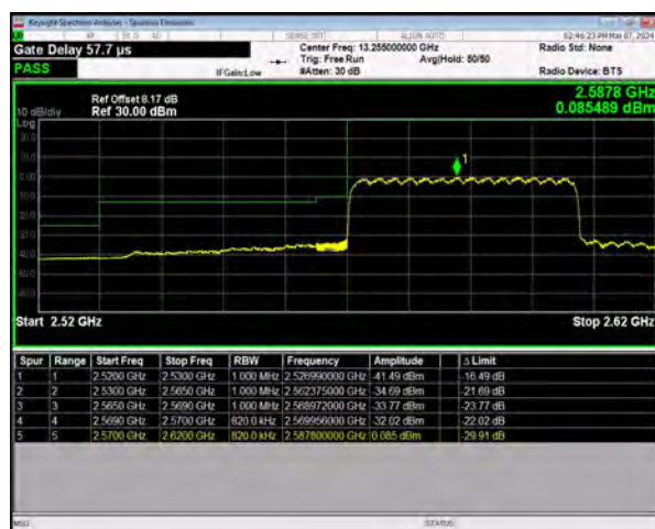
n38 SCS=30kHz DFT_QPSK BW=40MHz LowChannel=518000 RB=100@0
