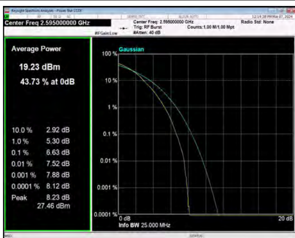
n38 SCS=30kHz DFT_256QAM BW=20MHz Channel=519000 RB=50@0
