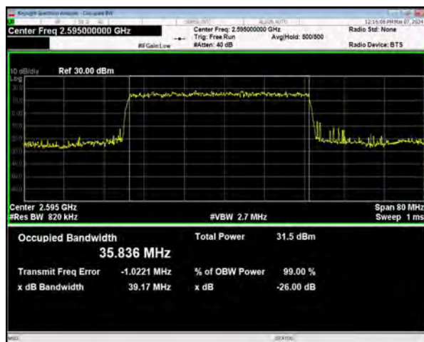
n38 SCS=30kHz DFT_BPSK BW=40MHz Channel=519000 RB=100@0
