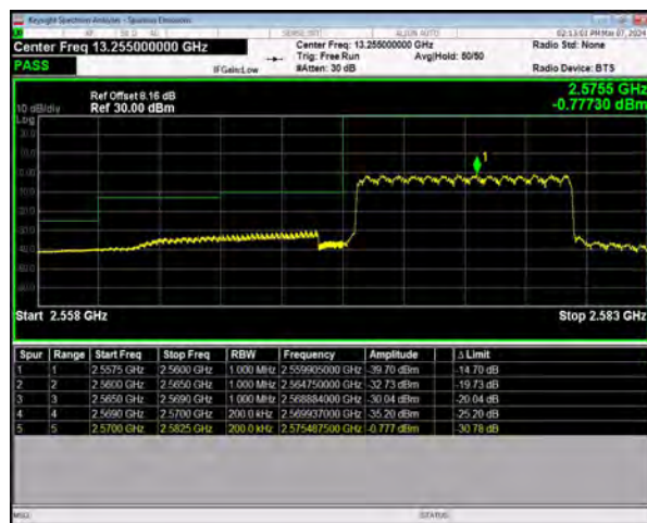
n38 SCS=30kHz DFT_QPSK BW=10MHz LowChannel=515000 RB=24@0
