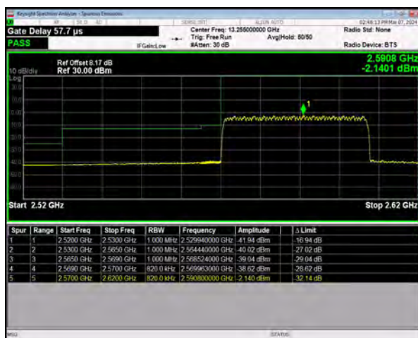
n38 SCS=30kHz DFT_64QAM BW=40MHz
