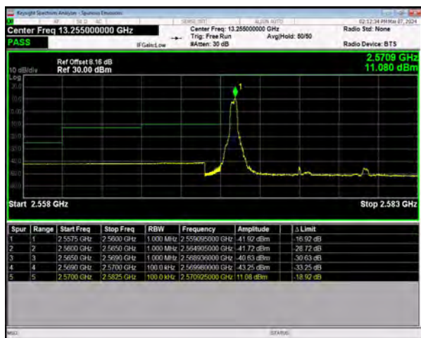
n38 SCS=30kHz DFT_QPSK BW=10MHz LowChannel=515000 RB=1@0
