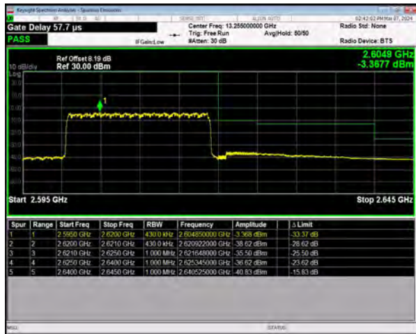
n38 SCS=30kHz DFT_16QAM BW=20MHz HighChannel=522000 RB=50@0
