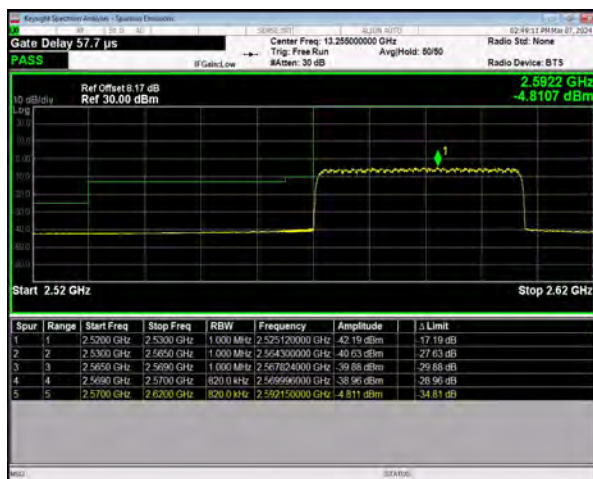
n38 SCS=30kHz DFT_256QAM BW=40MHz
