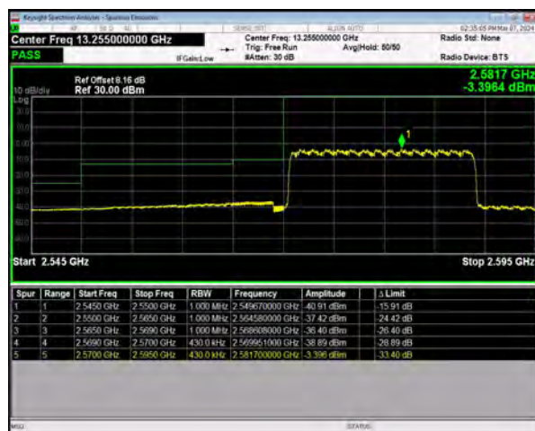
n38 SCS=30kHz DFT_16QAM BW=20MHz
