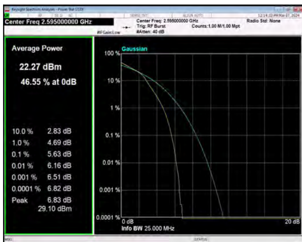
n38 SCS=30kHz DFT_16QAM BW=20MHz Channel=519000 RB=50@0
