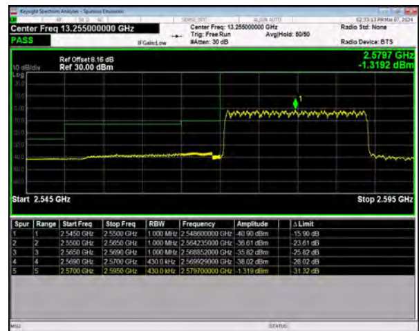
n38 SCS=30kHz DFT_BPSK BW=20MHz LowChannel=516000 RB=50@0
