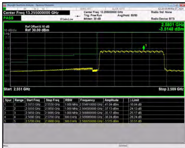
n38 SCS=30kHz CP_QPSK BW=15MHz LowChannel=515500 RB=38@0
