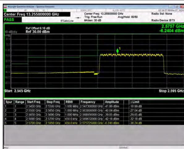
n38 SCS=30kHz DFT_256QAM BW=20MHz
