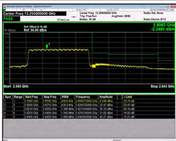
n38 SCS=30kHz DFT_QPSK BW=20MHz HighChannel=522000 RB=50@0
