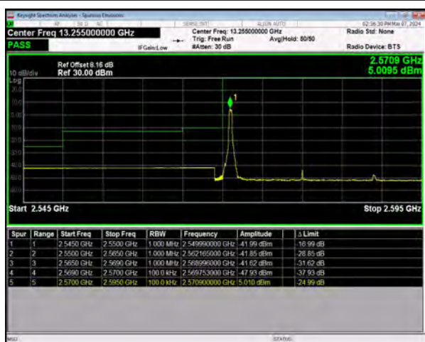
n38 SCS=30kHz DFT_256QAM BW=20MHz
