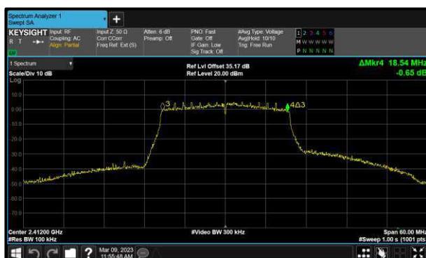
Figure 59 - 802.11ax HE20 SU Minimum 6 dB EBW
