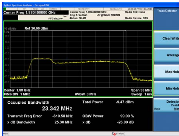
CA_2C 5MHz+20MHz 64QAM
